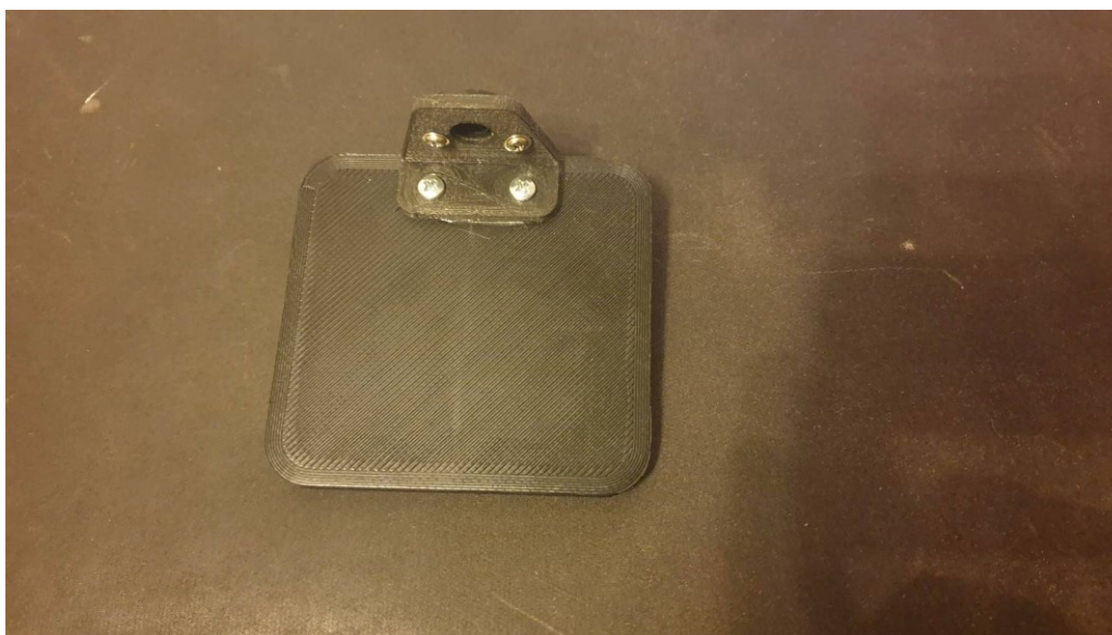
Slika 37 Spoj platforme i uške
