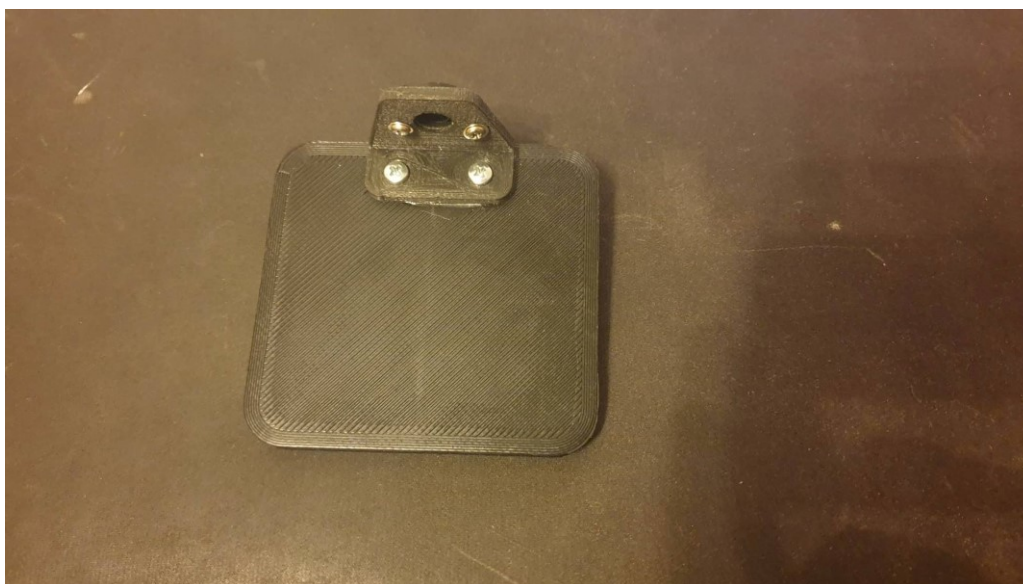
Slika 37 Spoj platforme i uške
