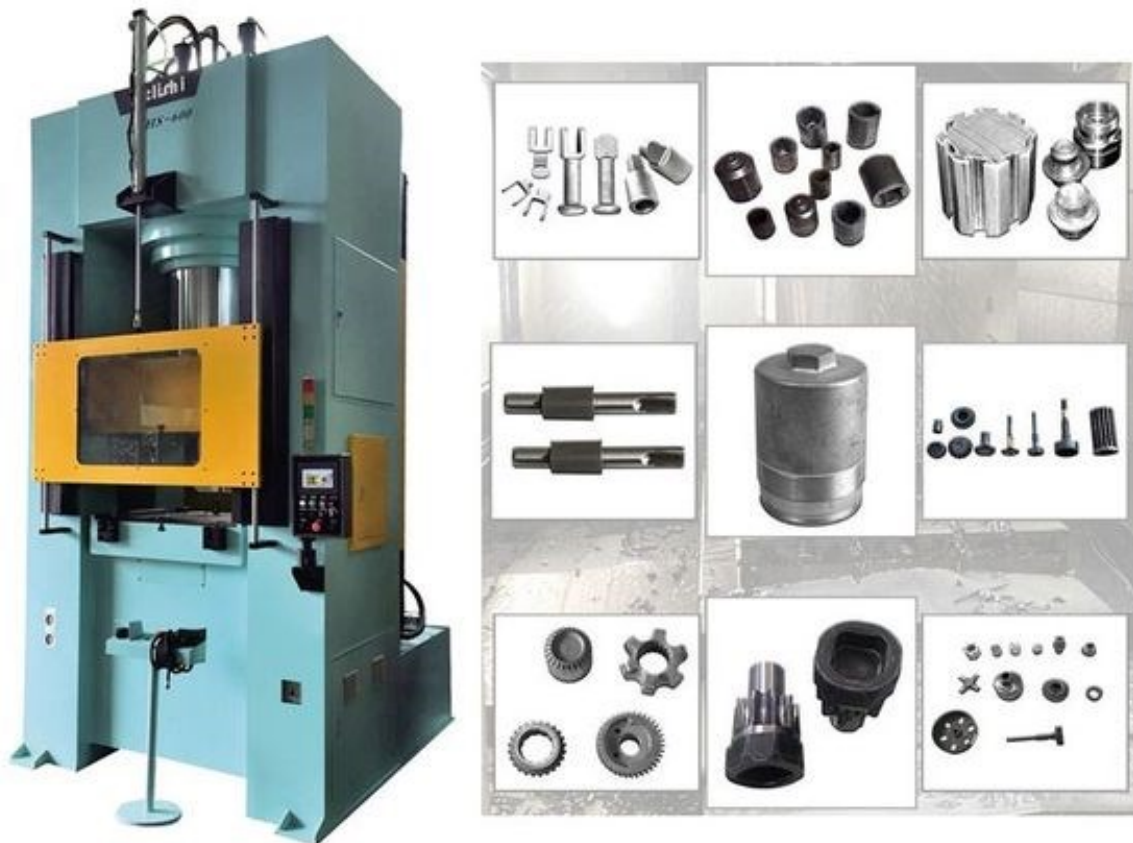
Slika 9. Preša za hladno kovanje u automobilskoj industriji [8]
