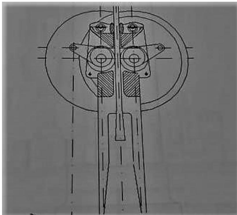
Slika 14. Mehanizam za dizanje malja s daskom [12]
