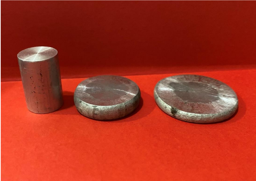
Slika 30. Valjčići tlačeni različitim silama kod preše
