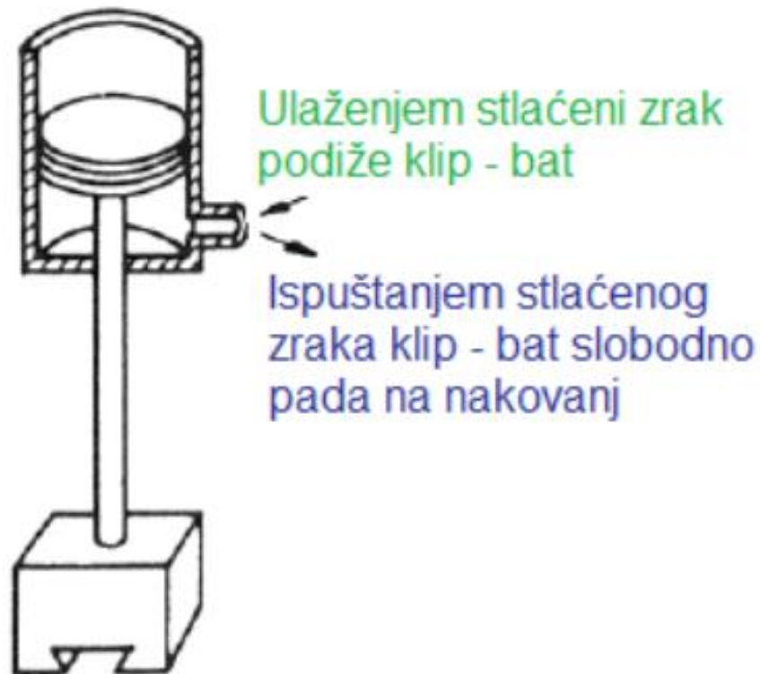
Slika 18. Jednoradni bat za slobodno kovanje [9]
