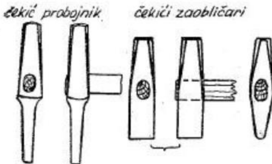
Slika 9. Čekić probojnik i čekić zaobljačar [1]
