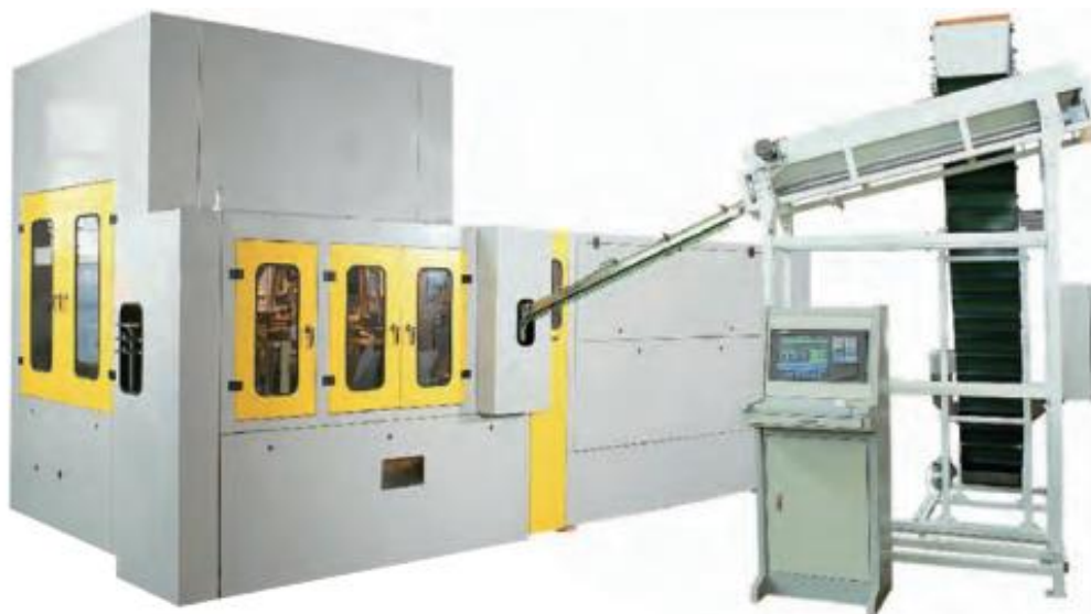
Slika 40. Automatizirani rotacijski stroj za puhanje PET ambalaže za pivo [36]
