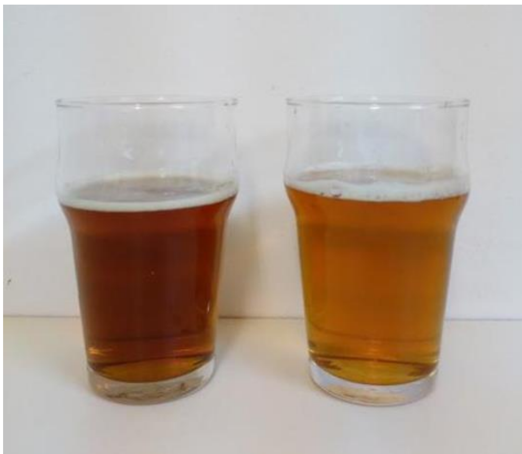
Slika 10. Oksidirani (lijevo) i neoksidirani (desno) uzorak piva [17]
