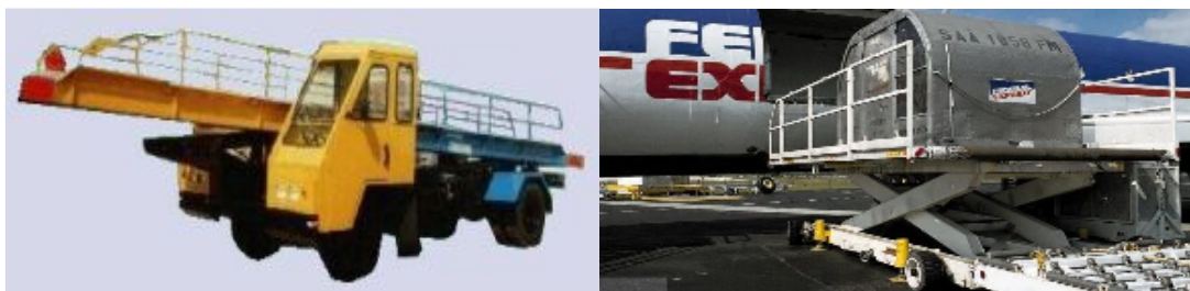
Slika 2.5. Vozilo – konvejer za utovar prtljage i tereta u zrakoplov
