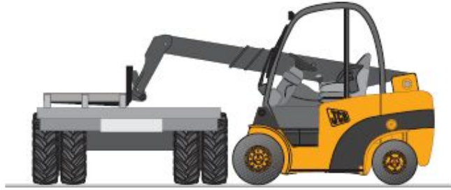
Slika 2.9. Dohvat palete sa teretnog vozila (teleskopski viličar)
