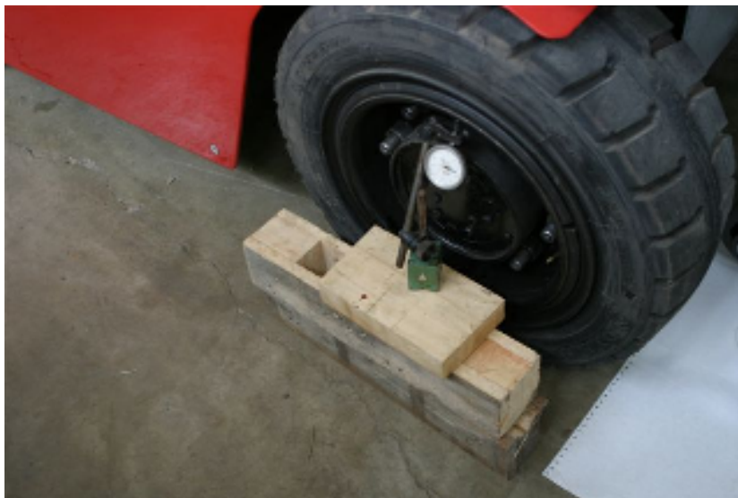
Slika 3.6. Postupak mjerenja statičkog progiba prednje gume viličara
