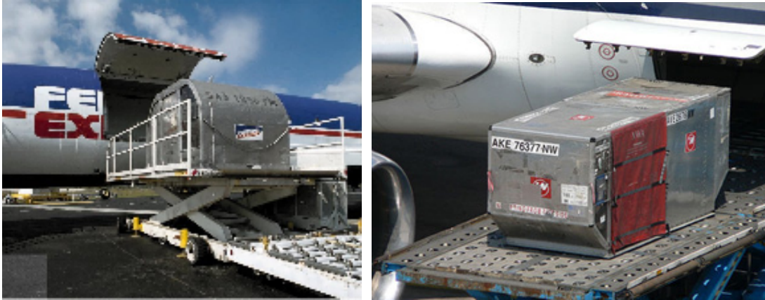
Slika 2.7. Lijevo - utovar kroz glavna vrata teretnog zrakoplova, desno – utovar u teretni prostor putničkog zrakoplova
