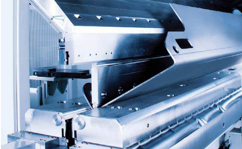
Slika 10. Alat na preši za profilno savijanje u zahvatu (detalj) [9]
