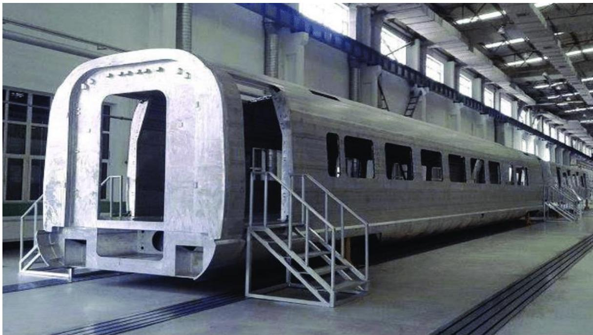
Slika 26: Konstrukcija vlaka od aluminija [18]
