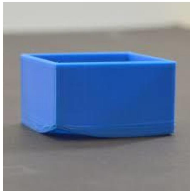
Slika 24: Savijanje slojeva [14]
