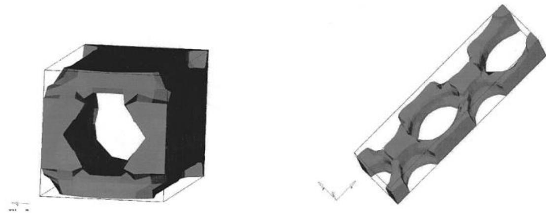
*Slika 20: Topološko optimiranje grede pod torzijskim opterećenjem [12]*
