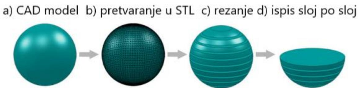
Slika 3: procesni lanac za 3D ispis modificirano prema [1]
