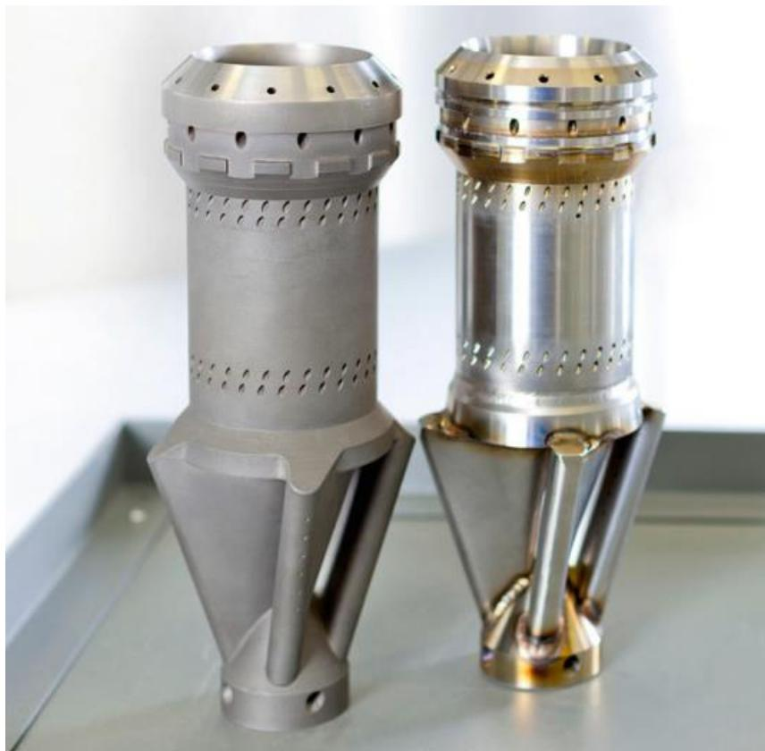
Slika 5: Siemens komora izgaranja plinske turbine [1]
