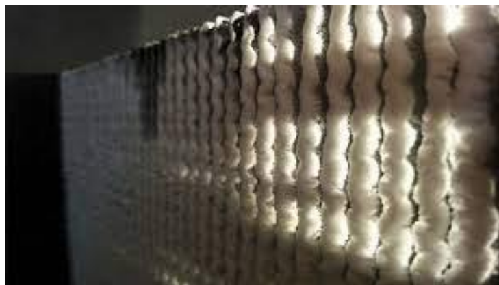
Slika 12 Porozna struktura leda [1]
