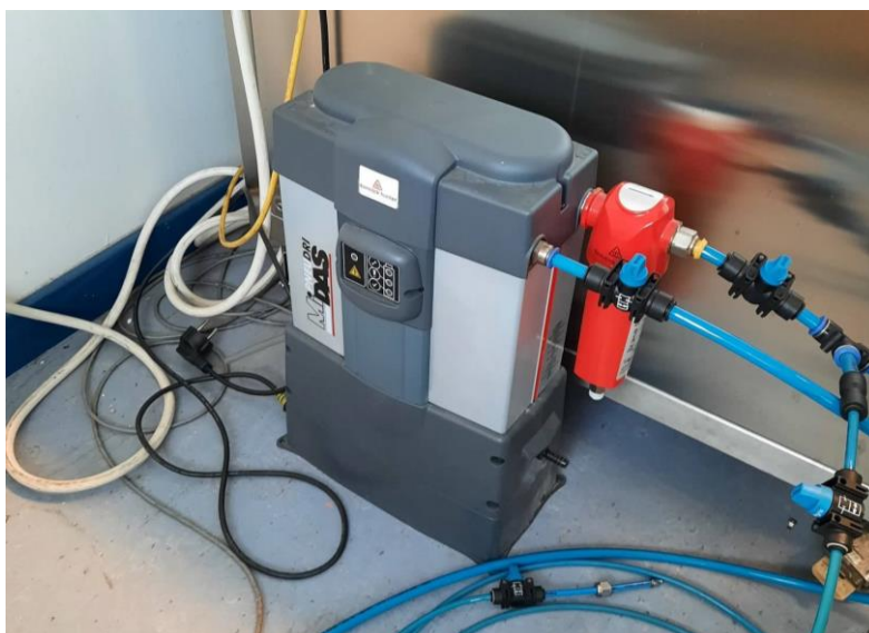
Slika 10. Adsorpcijski sušać zraka
