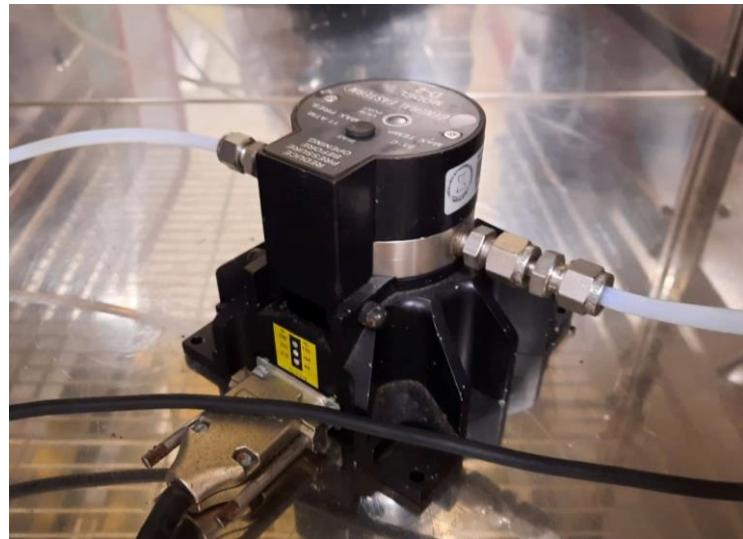
Slika 17. Etalonski higrometar točke rose
