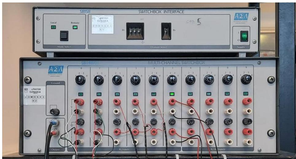
Slika 2. Multipleksor s komunikacijskom i upravljačkom jedinicom
