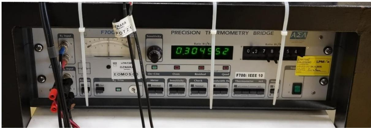
**Slika 3. Termometrijski otpornički most**
