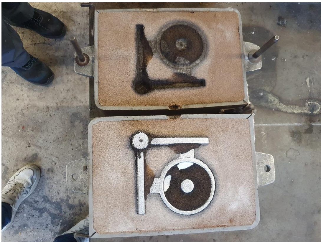
Slika 68. Razrušavanje kalupa Varijante 2
