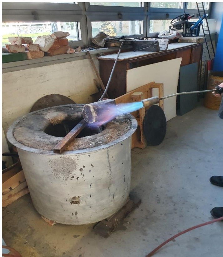
Slika 64. Zagrijavanje lonca za lijevanje
