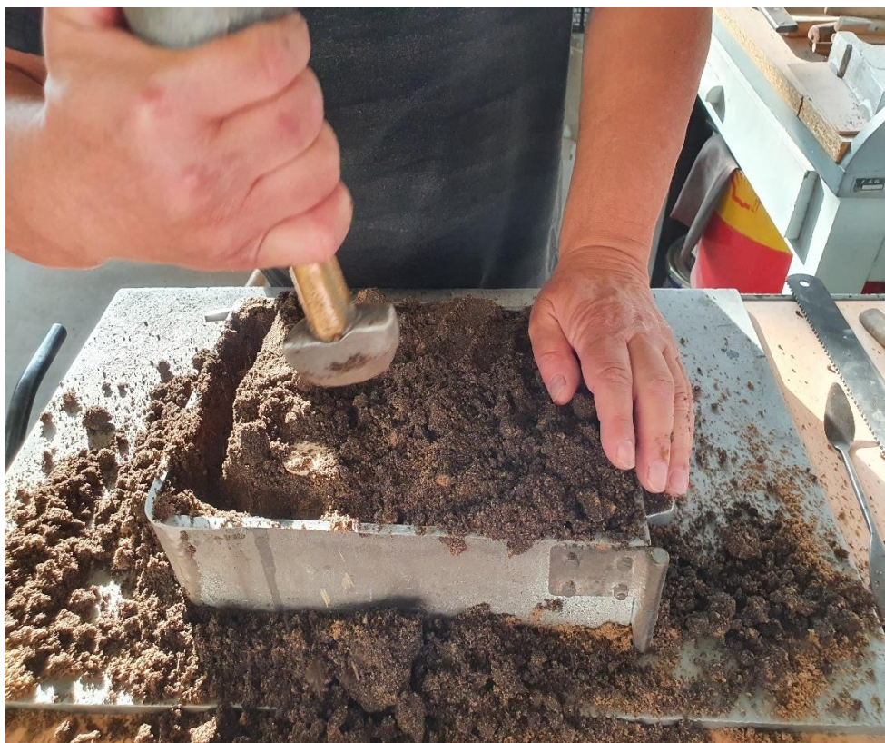
Slika 57. Sabijanje kalupne mješavine
