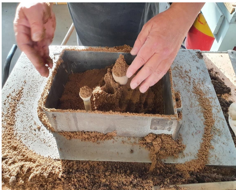
Slika 56. Nasipavanje kalupne mješavine
