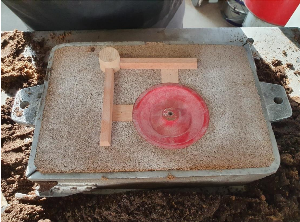
Slika 59. Pozicioniranje razvodnika i dna spusta u donjaku
