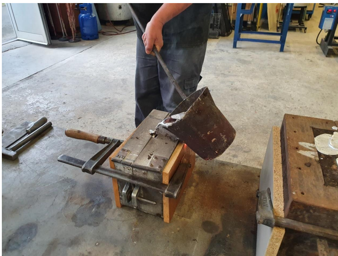
Slika 67. Lijevanje vertikalnih varijanti uljevnih sustava
