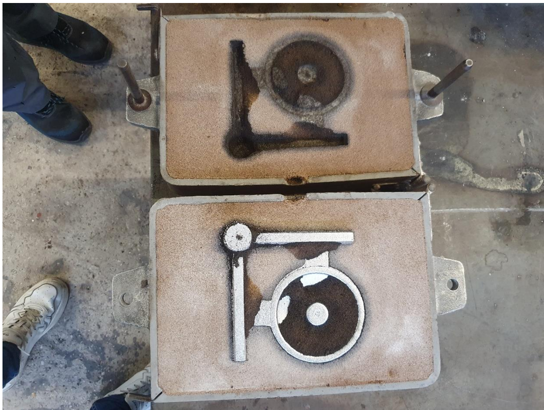
Slika 68. Razrušavanje kalupa Varijante 2
