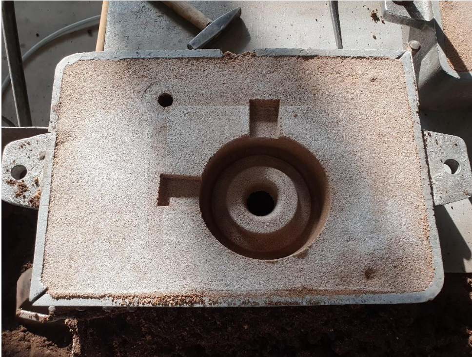
Slika 61. Izgled kalupne šupljine Varijante 2 u gornjaku
