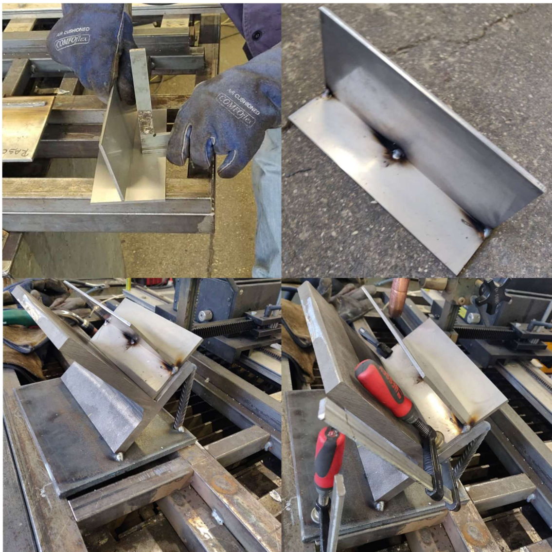
Slika 36. Priprema uzoraka za zavarivanje
