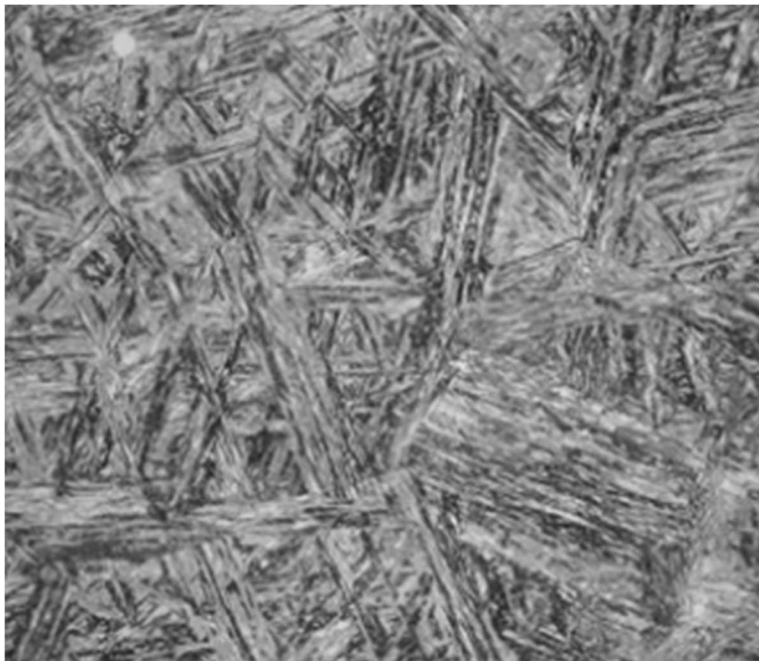
Slika 6. Mikrostruktura martenzitnog čelika [1]
