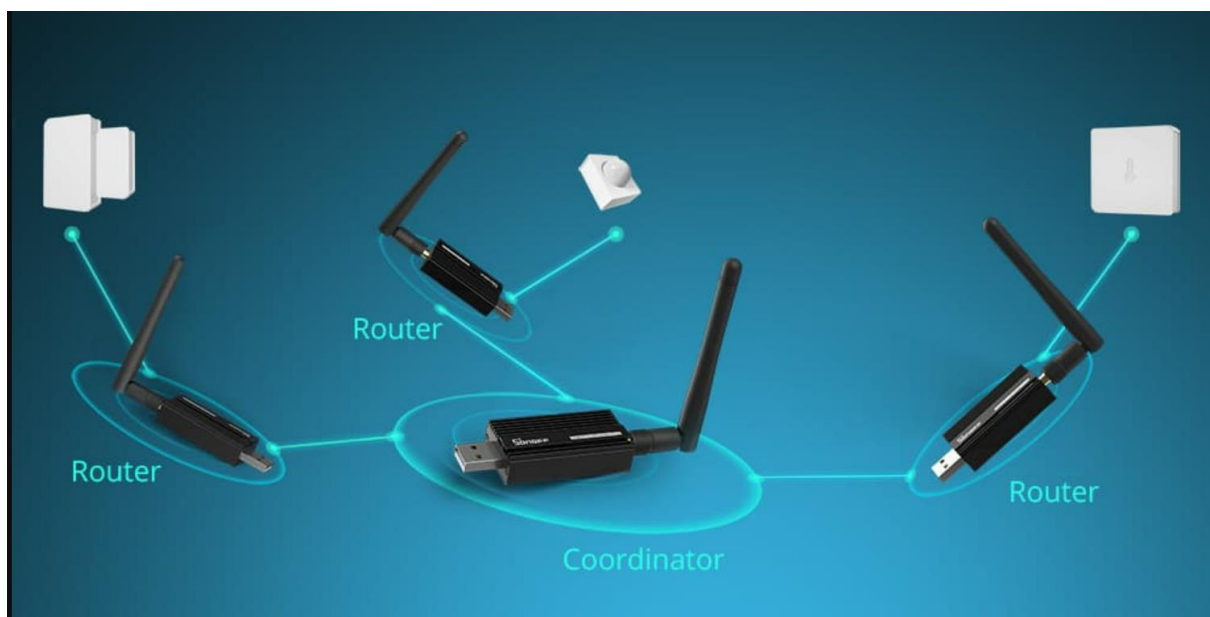
Slika 29. Prikaz rada u koordinatorskom i usmjerivačkom načinu rada
