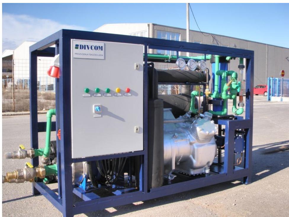
Slika 29. Uređaj za proizvodnju tekućeg leda TIP "S4" [21]
