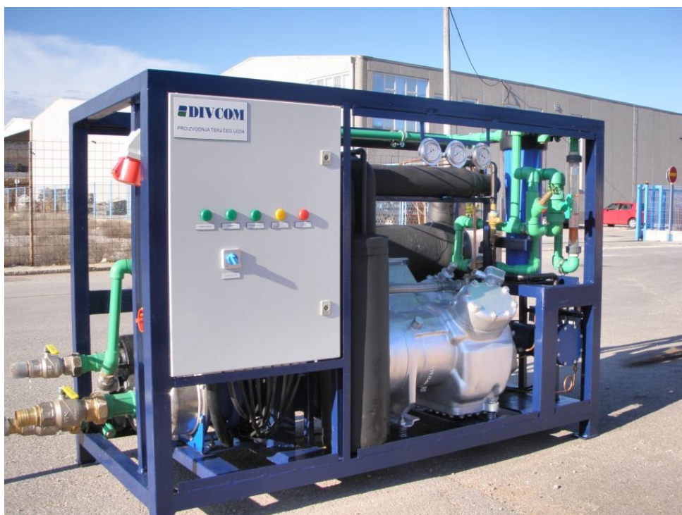
Slika 29. Uređaj za proizvodnju tekućeg leda TIP "S4" [21]
