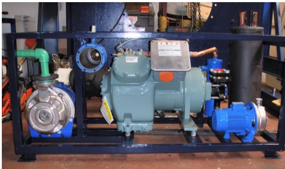
Slika 34. Kavezna izvedba sustava za proizvodnju leda u radionici [21]
