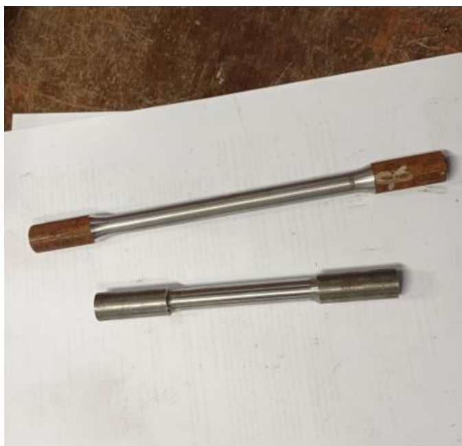
Slika 34. Proporcionalno kratki i proporcionalno dugi ispitni uzorak
