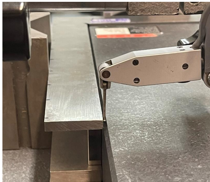
Slika 42 Mjerenje unutarnjeg kuta čeličnog kutnika
