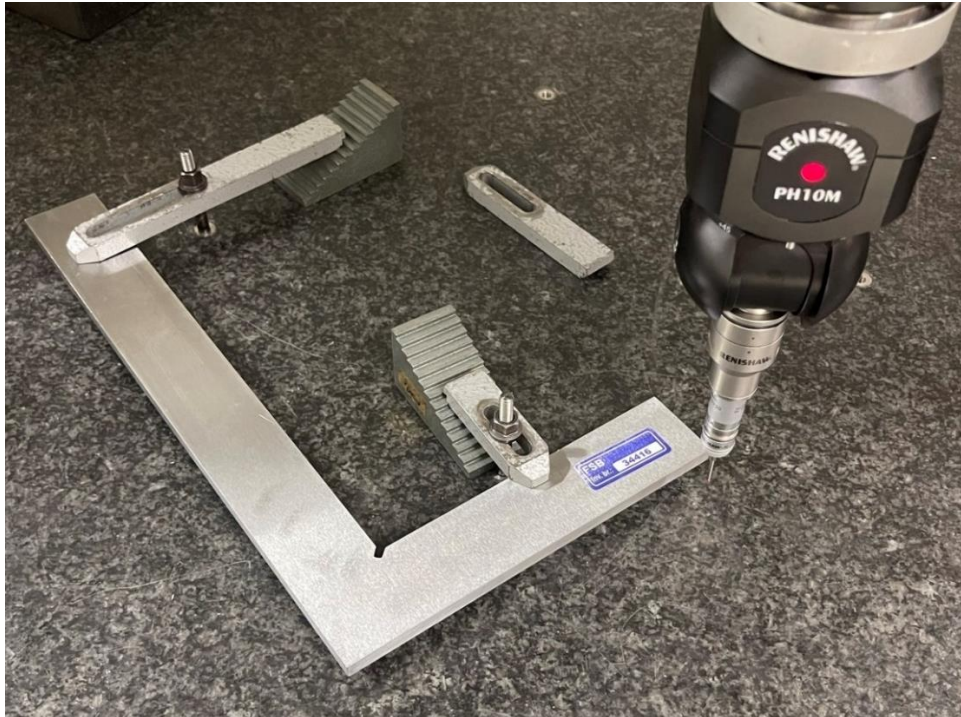
Slika 45 Način pričvršćivanja čeličnog kutnika na CMM-u
