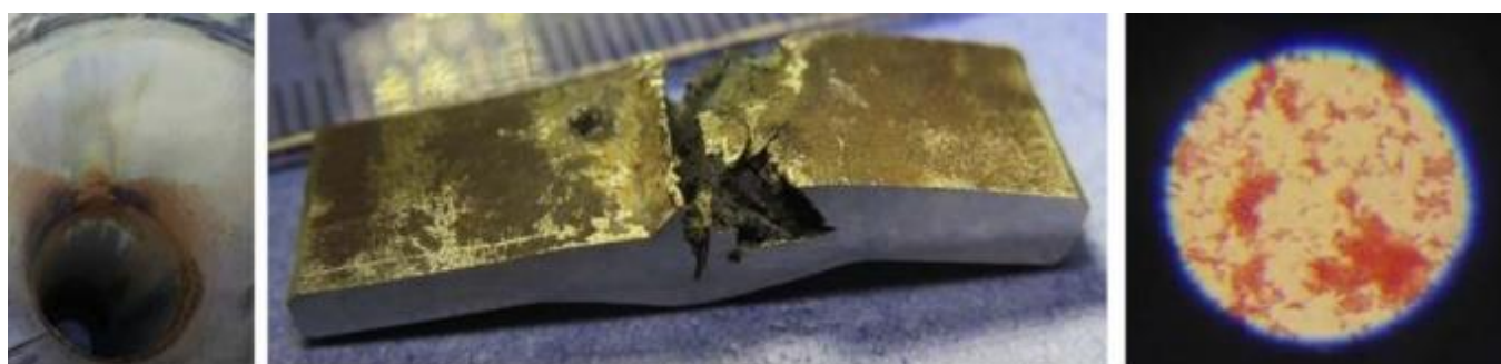
Slika 14. Korozija cjevovoda u podzemnoj garaži [18]
