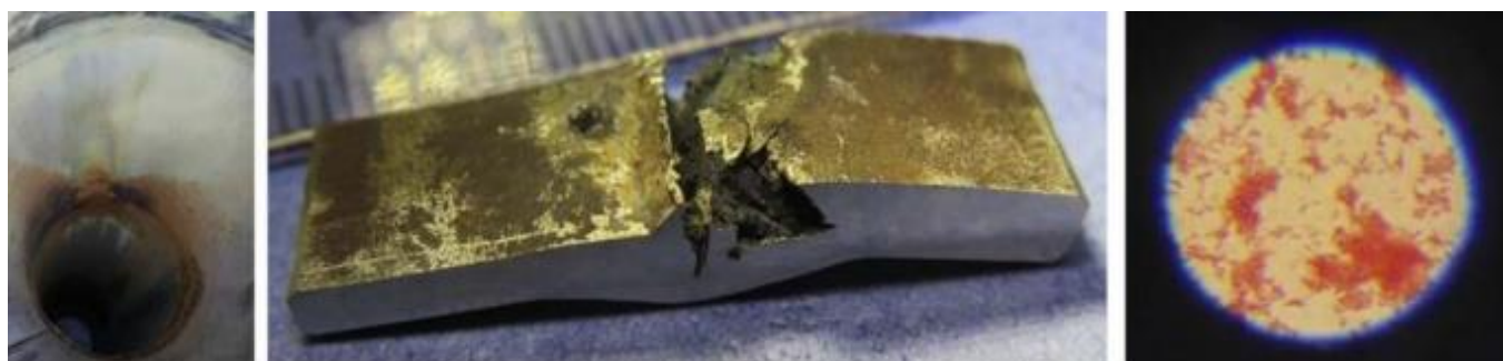
Slika 14. Korozija cjevovoda u podzemnoj garaži [18]
