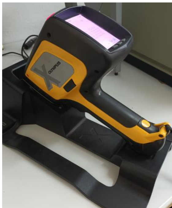
Slika 26. Uređaj za ispitivanje kemijskog sastava uzoraka - prijenosni X-Ray uređaj
