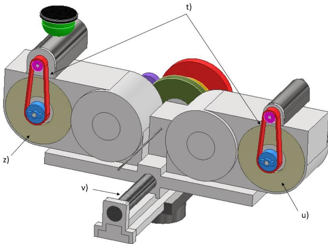
Slika 51. CAD koncept 5. t) remeni prijenos, u) mineralna vuna, v) vreteno, z) mineralna vuna
