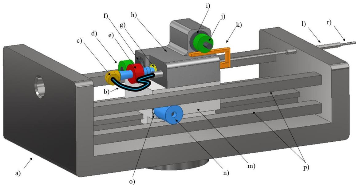
**Slika 43.** CAD koncept 3. a) nosiva platforma, b) vakuumska cijev, c) zglobni konektor, d) pogonski zupčanik, e) gonjeni zupčanik, f) elektromotor, g) rotacijski tuljac, h) kućište, i) pogonski elektromotor, j) zupčanik, k) nazubljena letva, l) plosnati izdanak za vođenje, m) glavna nosiva jedinica, n) zupčanik, o) pogonski elektromotor, p) nazubljeni tračni dio, r) biopsijska sonda
