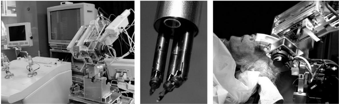
**Slika 12.** Mikromanipulatorski robotski sustav Neurobot (lijevo), vrh cilindra za umetanje u tkivo pacijenta (sredina), postavljanje vrha cilindra u pacijentovu lubanju (desno) [19]
