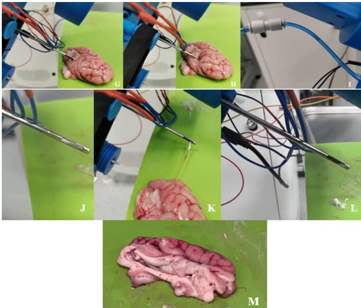
**Slika 110. Simulacija 2. (G) Pozicioniranje utora na vrhu sonde, (H) translatorno gibanje sonde unutar svinjskog moždanog tkiva, (I) prikaz djelovanja vakuuma, (J) bioptirani komadić tkiva, (K) izbacivanje bioptiranog komadića tkiva, (L) izbačeni uzorak tkiva, (M) svinjsko moždano tkivo (unutarnja struktura mekanog tkiva obavijenog staničnom opnom nalikuju sivo – bijelim nakupinama masnog tkiva obavijenih krvnim žilicama)**
