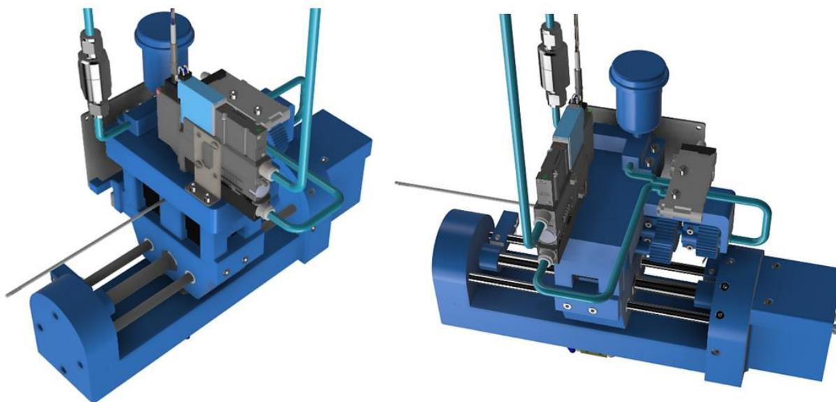
**Slika 113.**      **Renderirani prikazi pojednostavnjenog modela poboljšanog robotskog alata**
