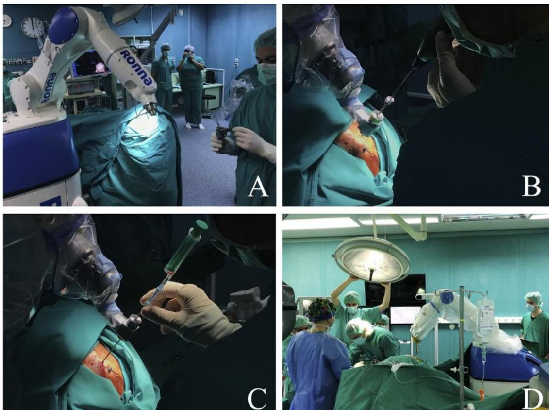
**Slika 27. (A) Postavljanje sterilizirane vodilje (nosača) za uvođenje biopsijske sonde, (B) postupak bušenja lubanje pacijenta te pozicioniranje robotske ruke u položaj za uvođenje sonde prema prethodno definiranoj trajektoriji, (C) pozicioniranje jednokratne biopsijske sonde te provođenje postupka biopsije, (D) završetak operativnog zahvata te izbacivanje uzorka biopiranog moždanog tkiva na Petrijevu zdjelicu za slanje na daljnju analizu [33]**
