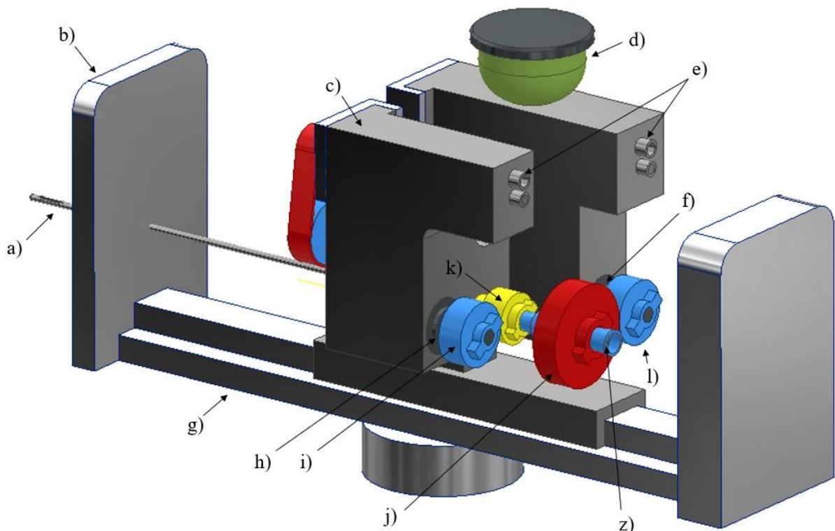
**Slika 46.** CAD koncept 4. a) biopsijska sonda, b) dio za vodenje sonde, c) središnji nosivi klizni dio, d) cilindrični lijevak s poklopcem, e) priključci za cjevčicu, f) pogonski elektromotor, g) klizno kućište, h) pogonski elektromotor, i) pogonski zupčanik 1, j) gonjeni zupčanik 2, k) gonjeni zupčanik 1, l) pogonski zupčanik 2, z) mjesto priključivanja vakuumske cjevčice na sondu
