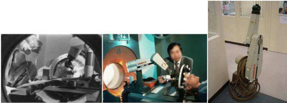
**Slika 4. Puma 200, prvi robotski sustav korišten kao asistent u neurokirurgiji:
