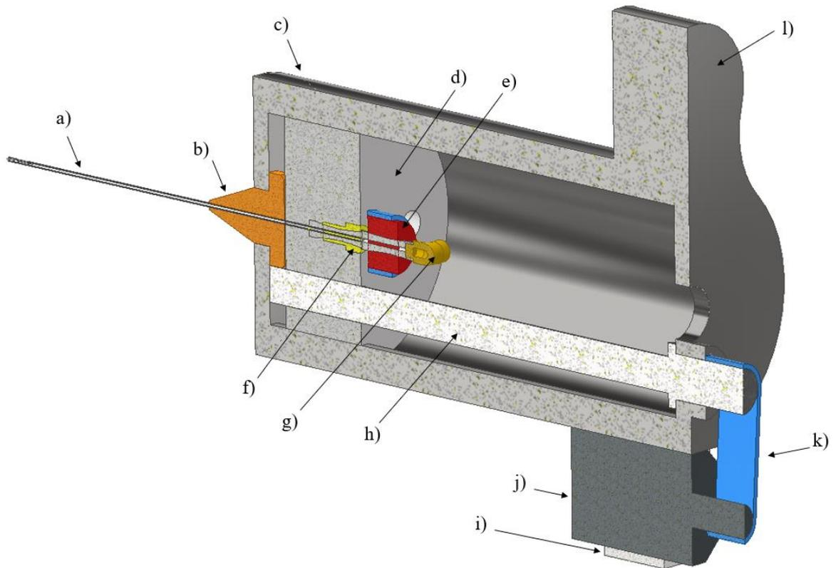
**Slika 41.** Presjek CAD koncepta 2. a) biopsijska sonda, b) konični umetak, c) cilindrično kućište, d) nosivi disk, e) zupčanik, f) spojni element, g) zglobni konektor, h) središnje vreteno, i) pravokutni držač, j) glavni pogonski elektromotor, k) remeni prijenos, l) geometrijski dio cilindričnog kućišta
