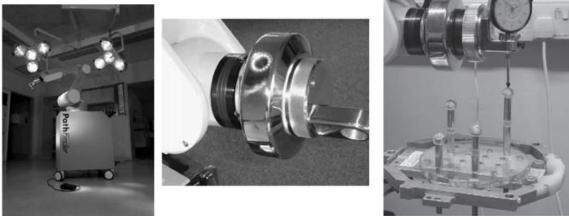
Slika 14. Pathfinder robotski sustav (lijevo), uvećani prikaz vrha alata s vizijskim sustavom (sredina), prikaz preciznosti pri dodiru sfernog objekta (desno) [21]
