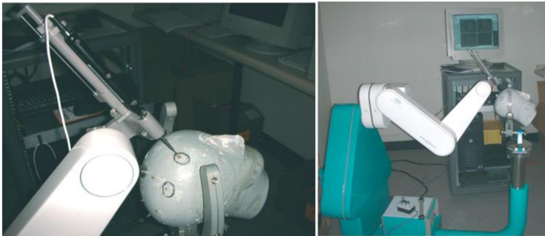
Slika 6. Postavljeni pokazivač s infracrvenim odašiljačima (lijevo) [8] i prikaz provođenja testa preciznosti (desno) [9]
