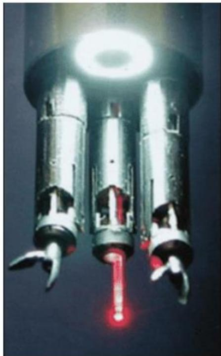
**Slika 13.** Uvećani prikaz vrha cilindričnog alata za odsijecanje [20]
