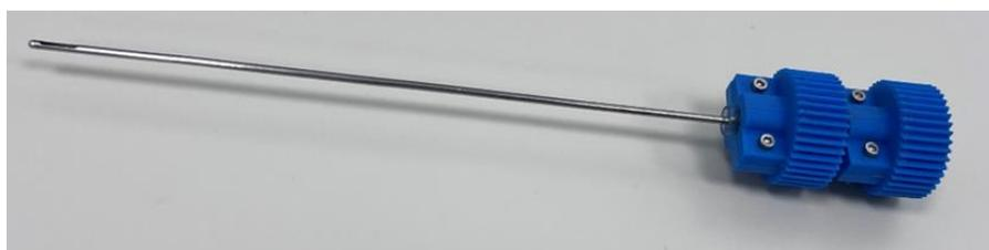
**Slika 90.** Montaža gonjenih zupčanika 1 i 2 na biopsijsku sondu
