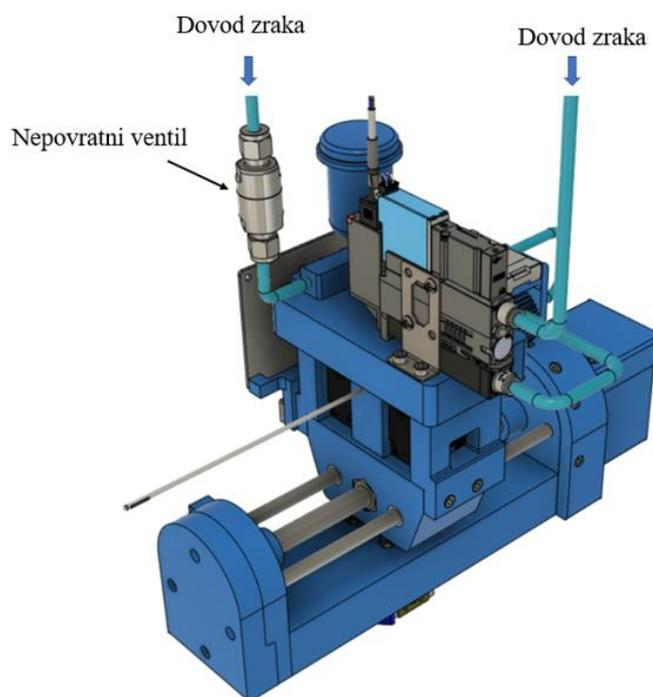
**Slika 111.** Pojednostavljeni CAD model poboljšanog robotskog alata
