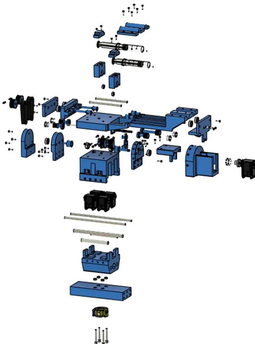
**Slika 77.** Izometrijski prikaz dijelova prototipa
