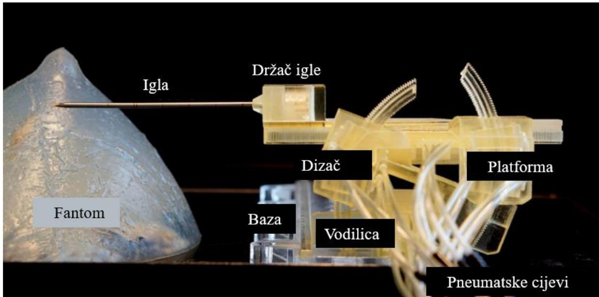
Slika 32. Stormram 4 robotski sustav [36]
