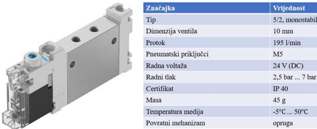
**Slika 67. Solenoidni monostabilni 5/2 ventil marke FESTO (lijevo), tablični prikaz karakteristika (desno) [66]**
