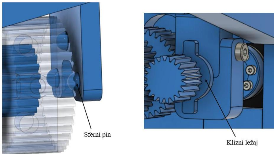
**Slika 66.** Uvećani prikaz sfernih pinova te kliznog ležaja
