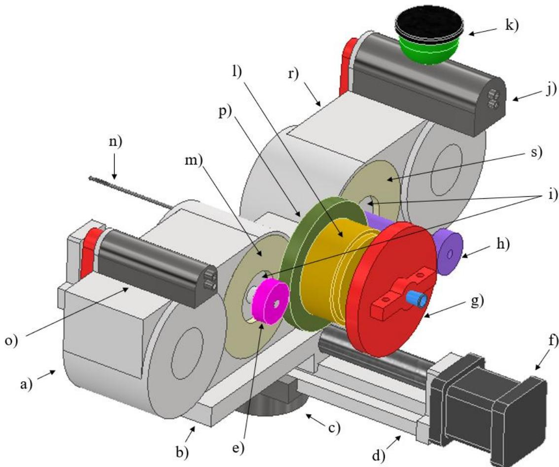
**Slika 50.** CAD koncept 5. a) kućište 1, b) nosiva platforma, c) pribubnica, d) profilna vodilica, e) pogonski zupčanik 1, f) pogonski elektromotor, g) gonjeni zupčanik 2, h) pogonski zupčanik 2, i) elektromotor, j) sustav za ubrizgavanje fiziološke otopine, k) cilindrični lijevak s poklopcem, l) prijenosno kolo, m) mineralna vuna, n) biopsijska sonda, o) sustav za ostvarivanje podtlaka, p) gonjeni zupčanik 1, r) kućište 2, s) mineralna vuna
