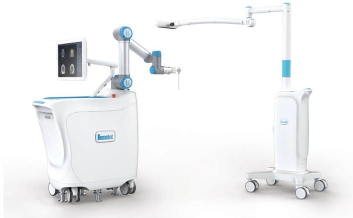
**Slika 10. Remebot, robotski sustav korišten u području neurokirurgije [17]**
