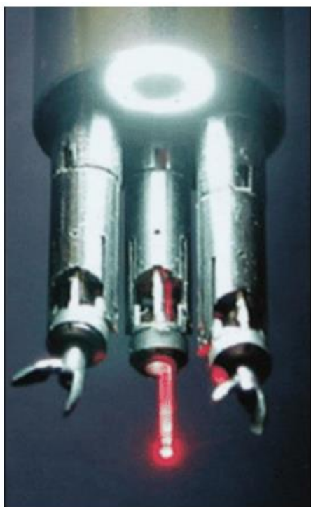
Slika 13. Uvećani prikaz vrha cilindričnog alata za odsijecanje [20]
