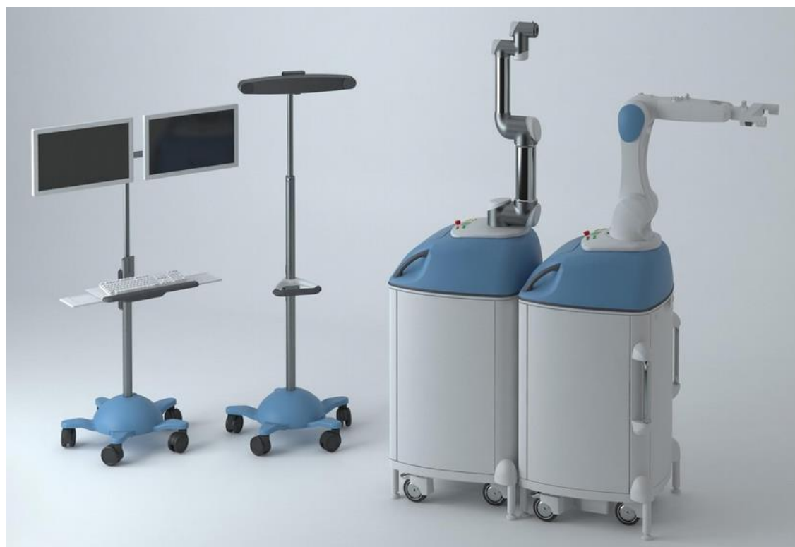
Slika 26. Dijelovi robotskog sustava RONNA [32]
