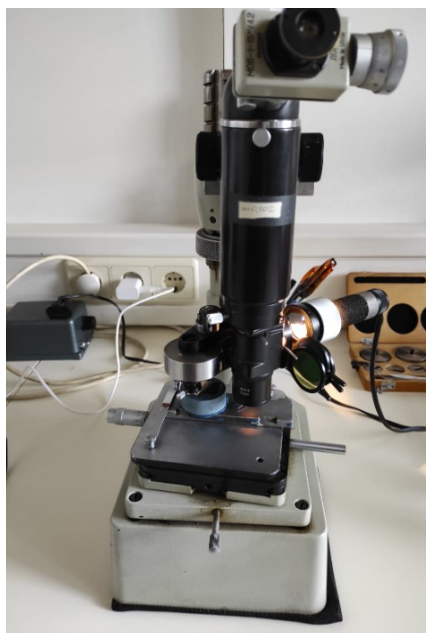
Slika 56 Uređaj za ispitivanje tvrdoće HV0,2
