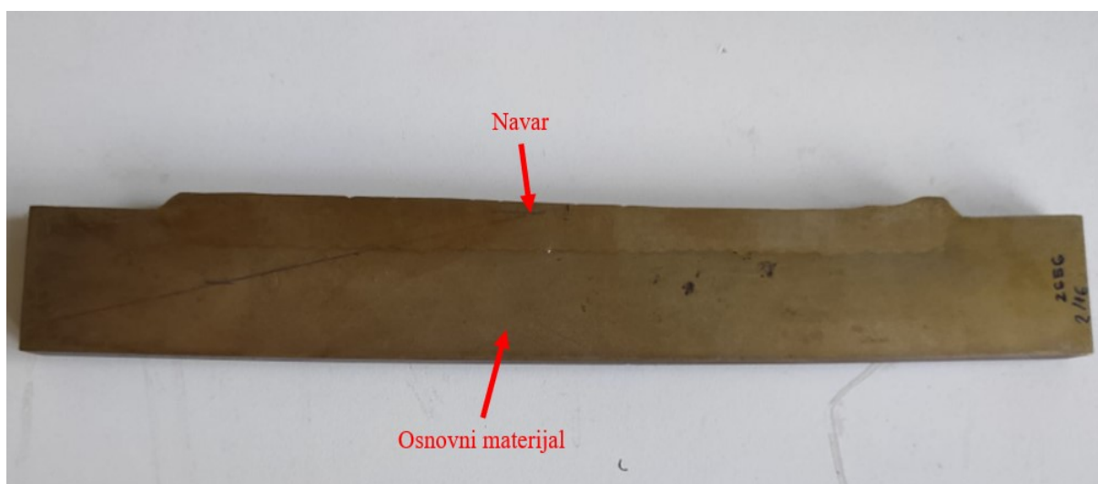
Slika 26 Uzorak osnovnog materijala s navarom
