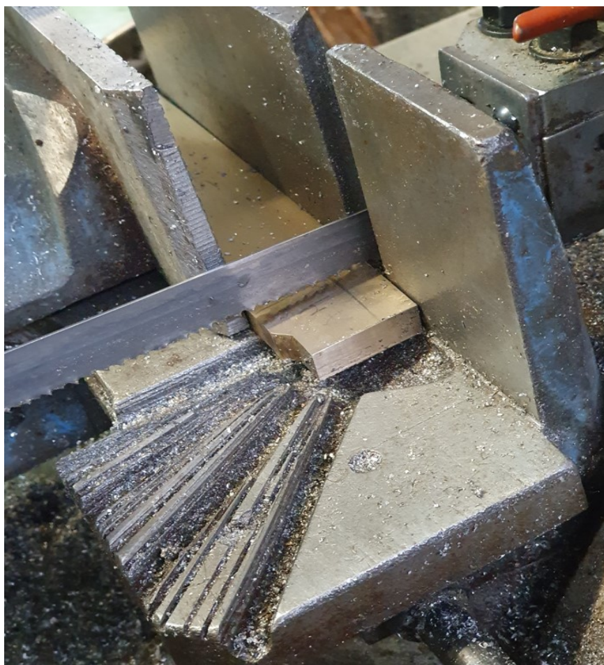
Slika 27 Rezanje uzorka pilom
