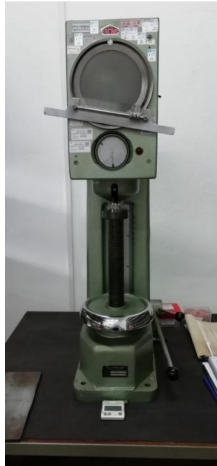
Slika 54 Uređaj za ispitivanje tvrdoće HV10
