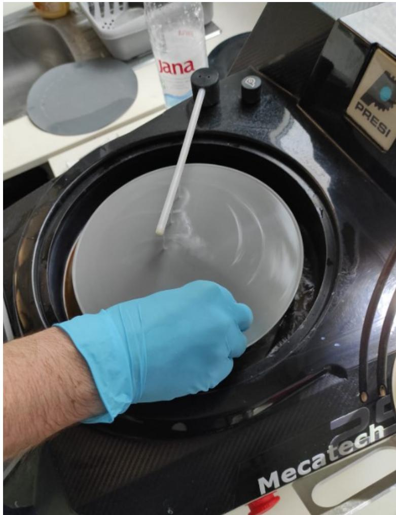
Slika 29 Brušenje uzorka
