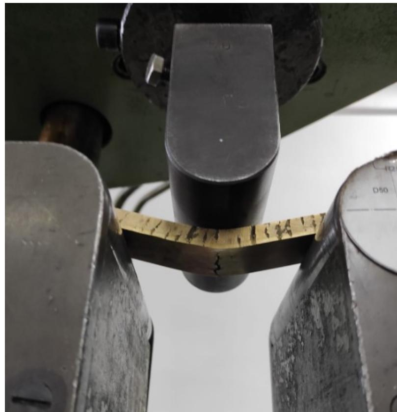
Slika 50 Pojava pukotine tijekom savijanja
