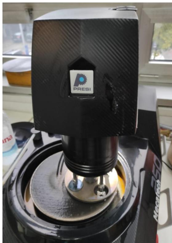
Slika 32 Poliranje uzorka
