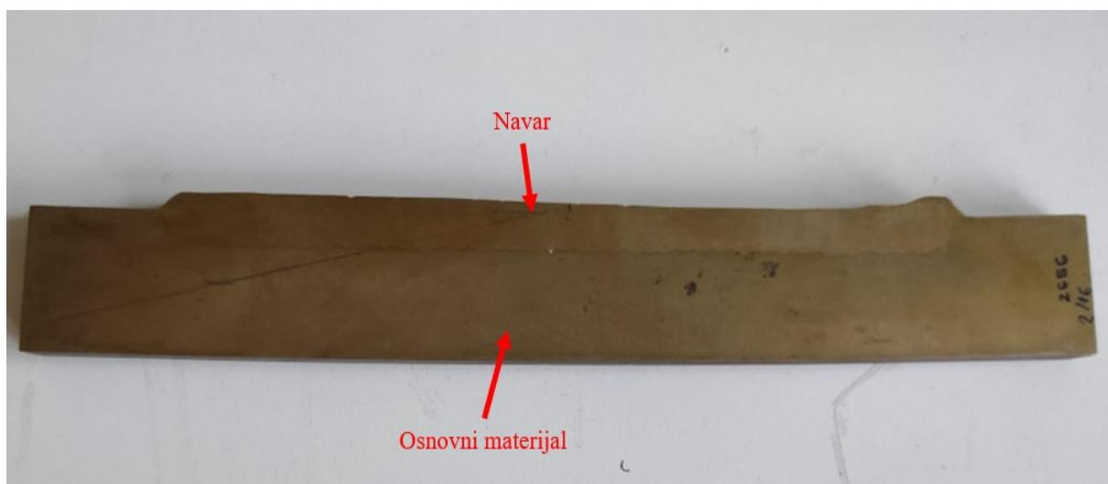
Slika 26 Uzorak osnovnog materijala s navarom
