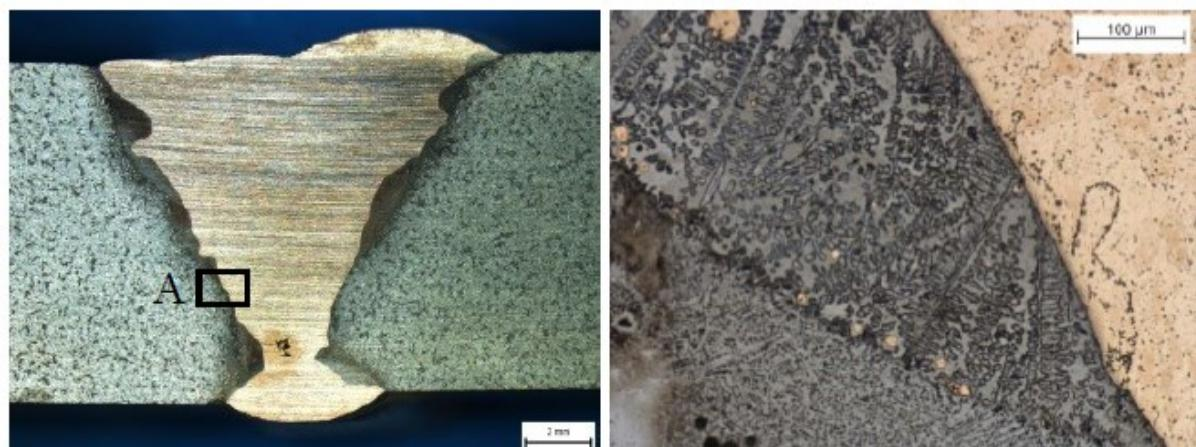
**Slika 22 Makrostruktura (lijevo) i mikrostruktura na lokaciji A za lemljeni spoj gdje je dodatni materijal bio CuSi3Mn1 (desno) [13]**
