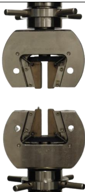
Slika 5.1. Mehaničke klinaste čeljusti proizvođača ZwickRoell
