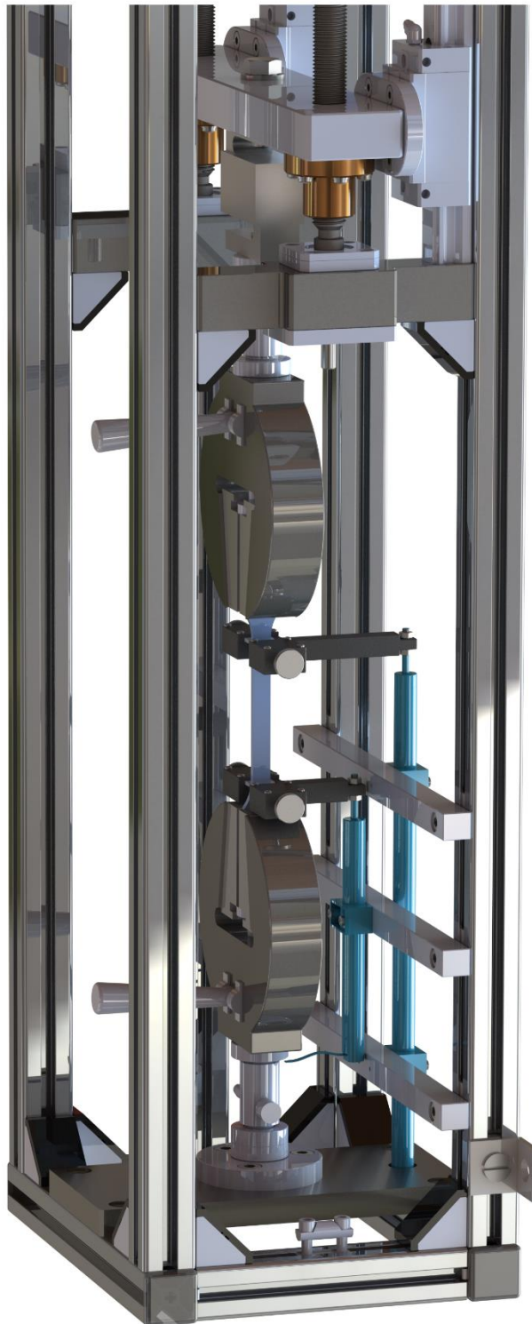
Slika 8.6. Donji dio kidalice
