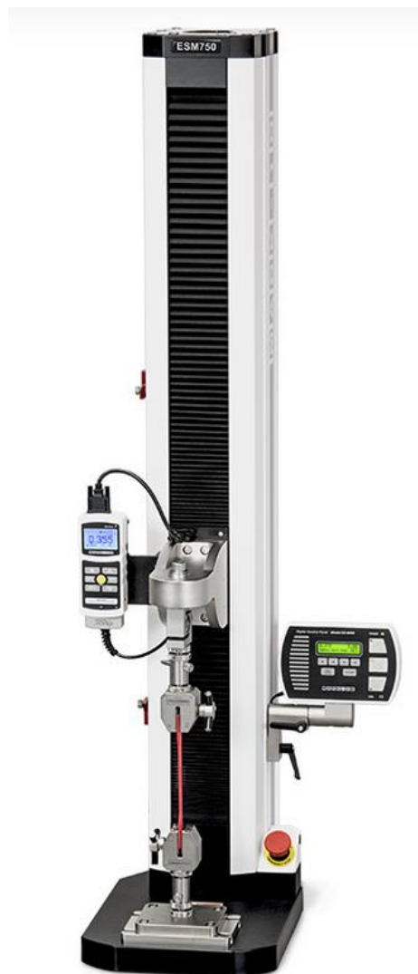
Slika 4.1. Mark-10 ESM750S Tensile Tester [12]
