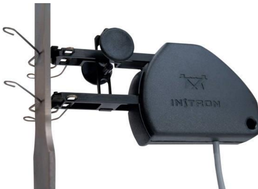
Slika 5.7. Mehanički nasadni ekstenzometar proizvođača Instron
