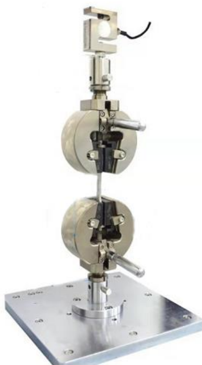
Slika 7.13. Set pretvornika sile, čeljusti i adaptera
