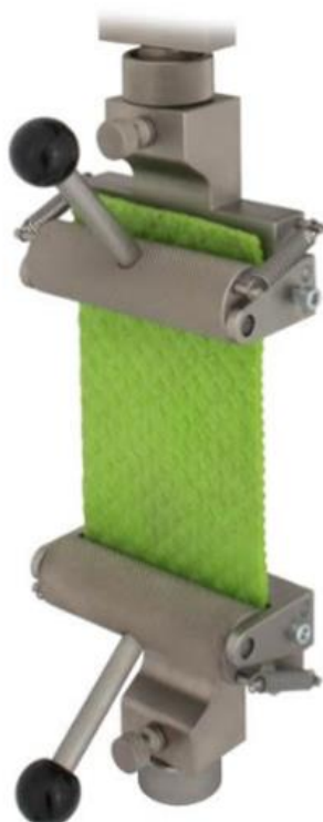
Slika 5.3. Mehaničke ekscentrične čeljusti
