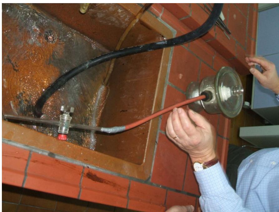
Slika 3.3. Uklanjanje mjehurića zraka u eksikatoru.
