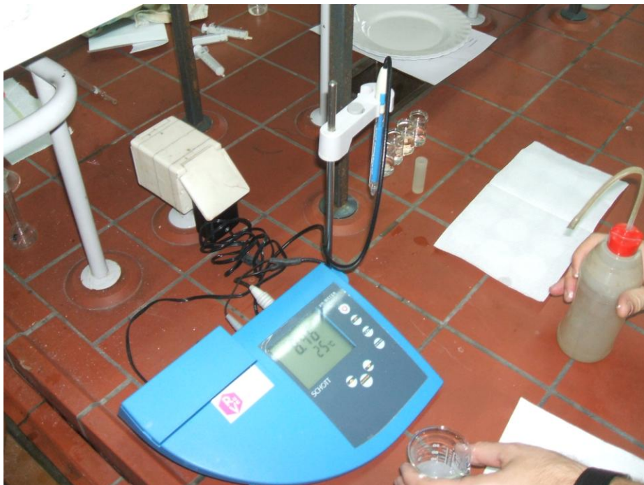
Slika 3.5. Mjerenje pH vrijednosti suspenzije.
