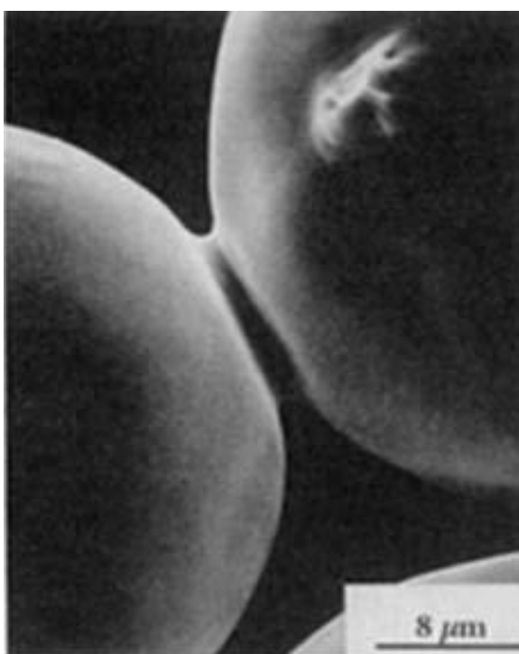
Slika 2.13. Stvaranje "vrata" na mjestu kontakta između čestica [22].
