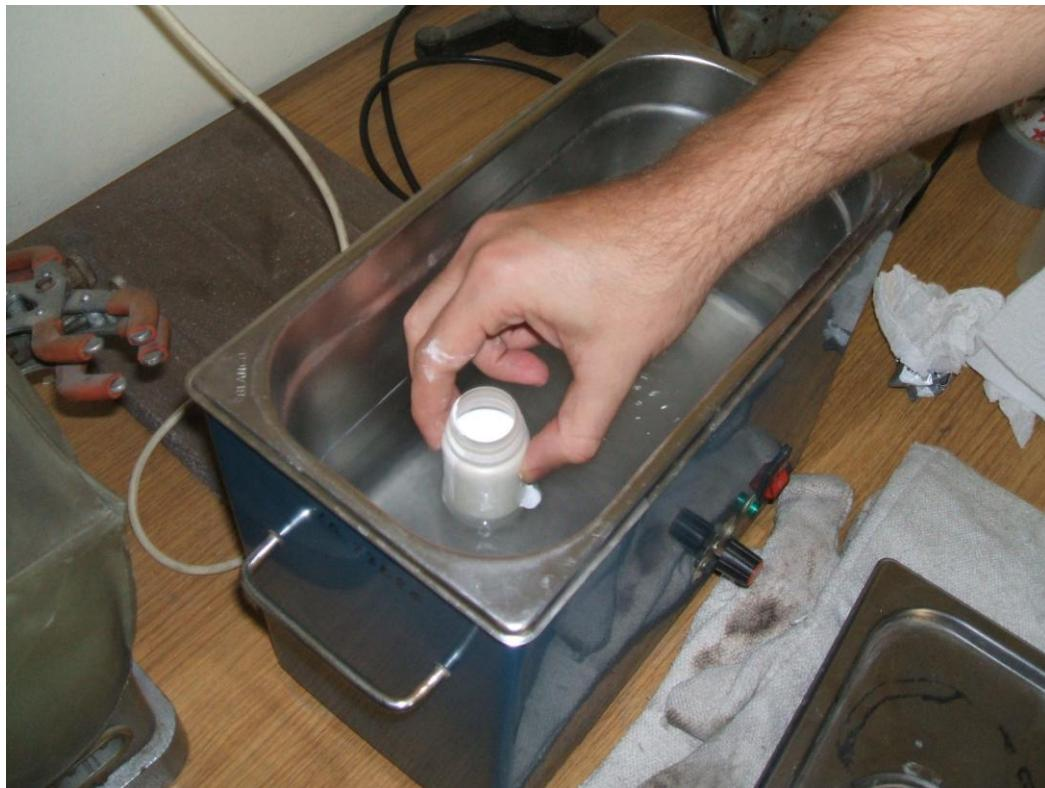
*Slika 3.4. Uklanjanje mjeđurića zraka u ultrazvučnoj kupelji.*
