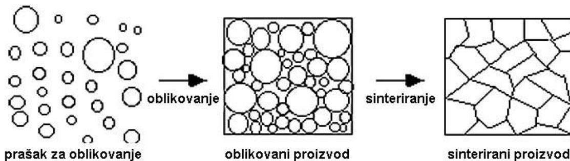
*Slika 2.7. Zgušnjavanje mase oblikovanjem za daljnju obradu (sinteriranje [21]).*
