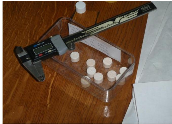
*Slika 3.8.. Pomična mjerka korištena za određivanje dimenzija uzoraka.*
