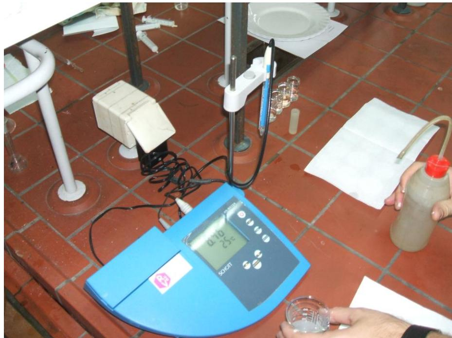
*Slika 3.5. Mjerenje pH vrijednosti suspenzije.*
