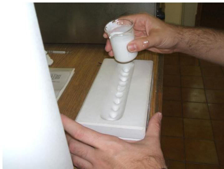
*Slika 3.6. Lijevanje u gipsani kalup*
