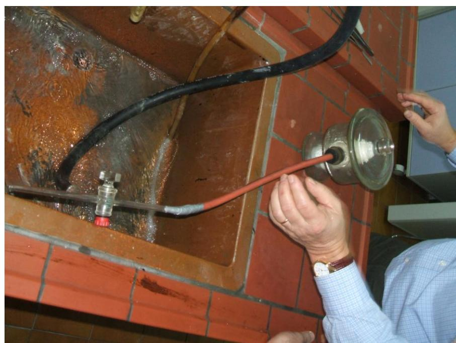
*Slika 3.3. Uklanjanje mjehurića zraka u eksikatoru.*
