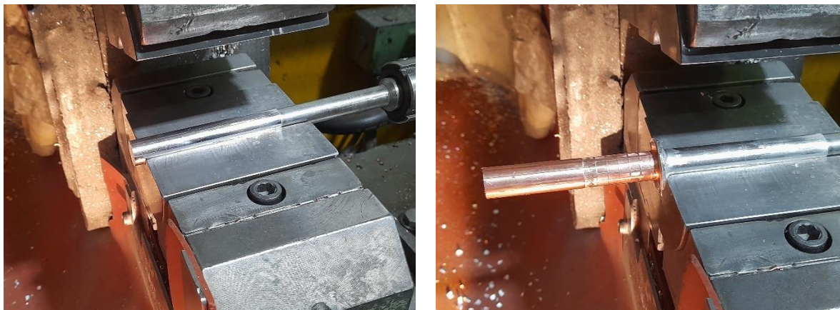
Slika 54. Montiranje sirovca – lijevo, izrada spoja - desno
