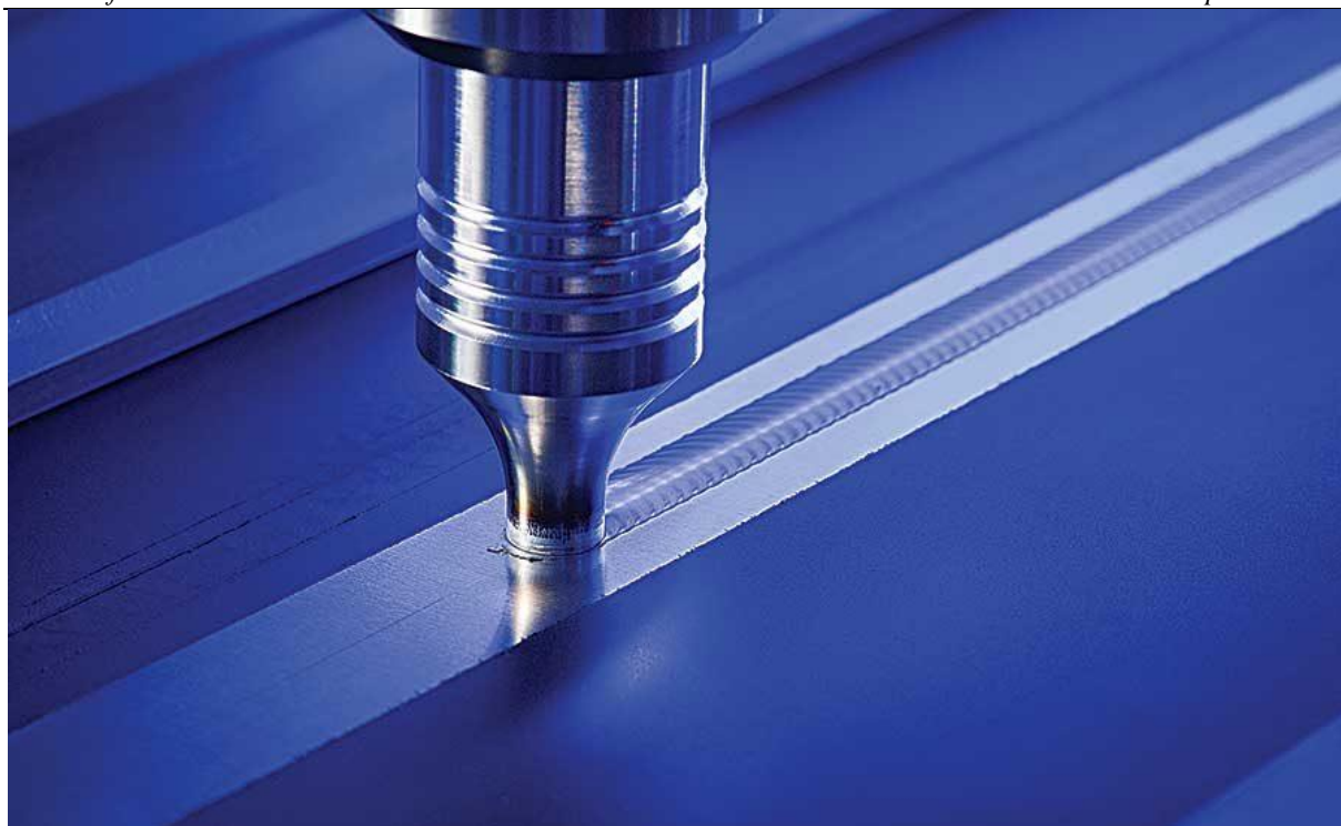
Slika 13. Zavarivanje trenjem rotirajućim alatom [10]
