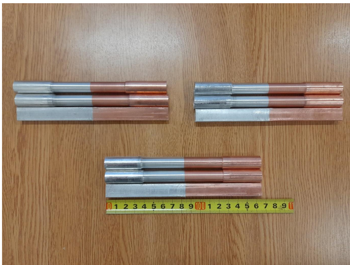
Slika 59. Pripremljeni uzorci podijeljeni u grupe i spremni za ispitivanje na vlačni test
