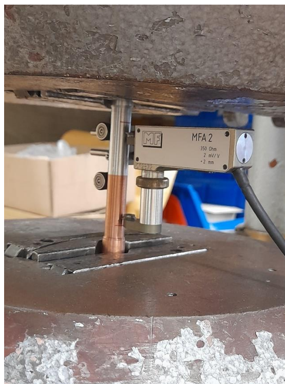
Slika 61. Montirana ispitna epruveta spremna na vlačni test
