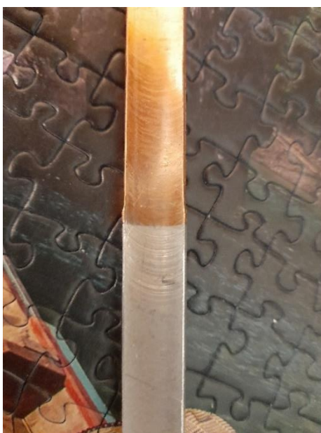
Slika 58. Primjer uzdužno izglođanog uzorka u svrhu ispitivanja mikrostrukture na Al-Cu spoju
