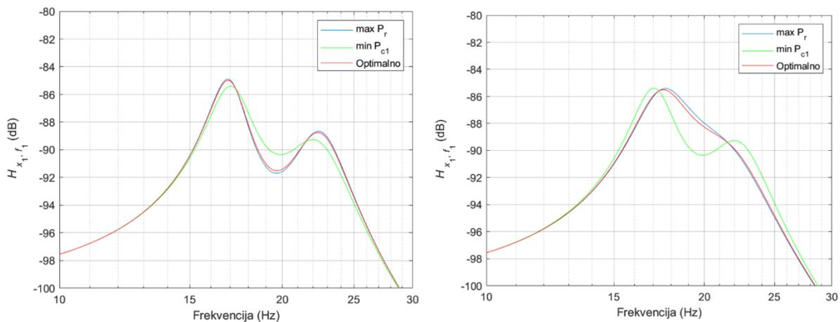
**Slika 5.16** Prijenosna funkcija  $H_{x_1, f_1}$  za slučaj maksimalne razvijene korisne snage  $P_r$ , minimalne disipirane snage na prigušivaču  $P_{c1}$  i višekriterijskog optimuma za  $c_2 = 5$  Ns/m (lijevo) i  $c_2 = 13.5$  Ns/m (desno)
