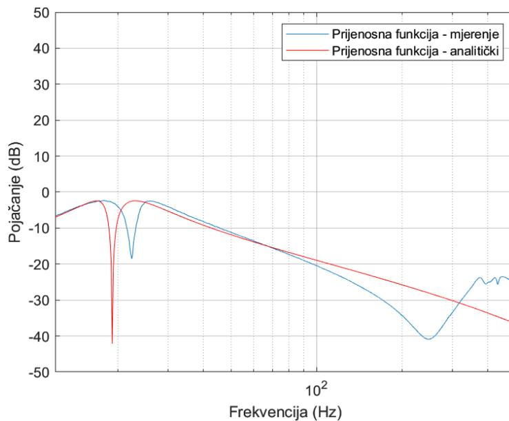
Slika 4.24 Usporedba dijagrama pojačanja dobivenih mjerenjem i analitički
