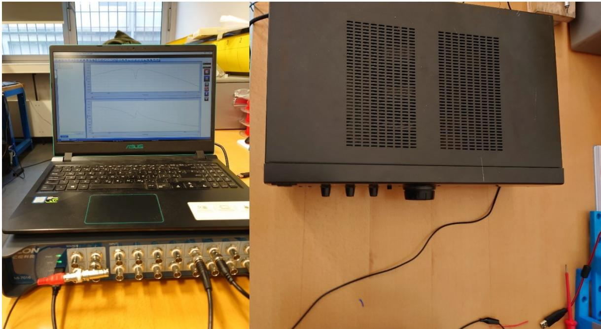
**Slika 4.22 Analizator spektra priključen na prijenosno računalo**
