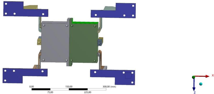
Slika 4.9 Rubni uvjet uklještenja na vertikalnim nosačima
