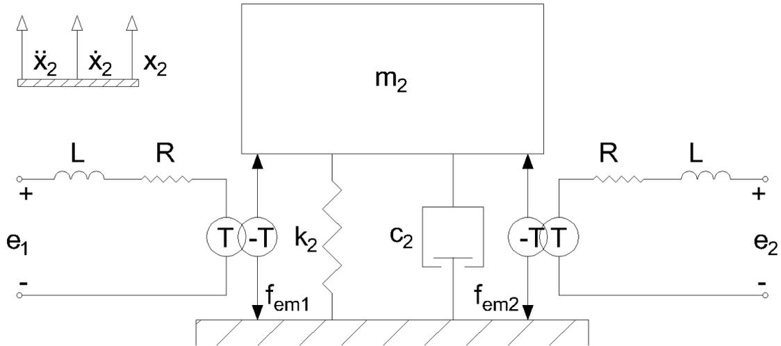
Slika 2.4 Matematički model uređaja za žetvu vibracija
