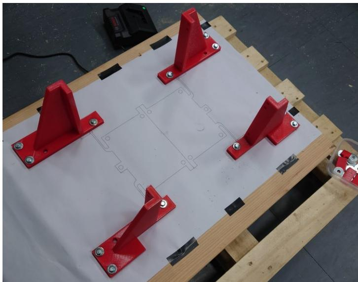
**Slika 4.19** Pozicioniranje vertikalnih nosača na drvenoj podlozi
