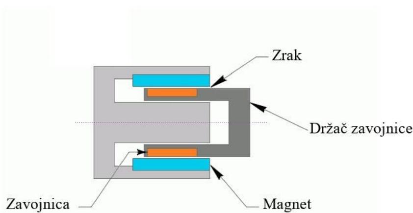
Slika 2.3 Shematski prikaz zavojnice i magneta
