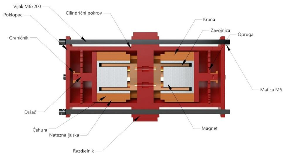
Slika 3.4 Presjek uređaja za žetvu vibracija sa označenim dijelovima sklopa
