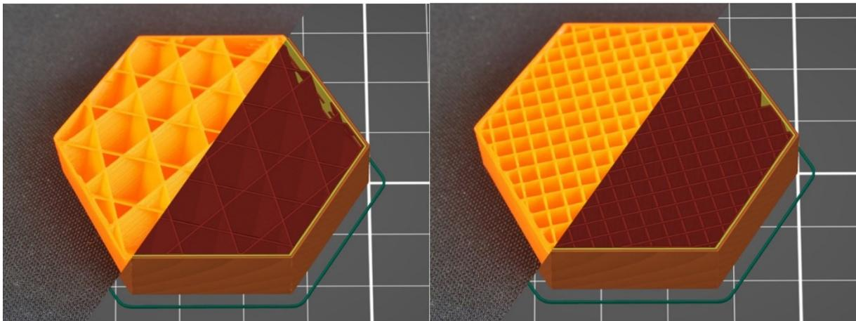
Slika 4.13 Cubic uzorak ispune (lijevo) i Rectilinear uzorak ispune (desno)
