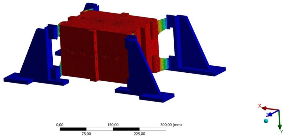
Slika 4.10 Prva forma vibriranja primarne strukture
