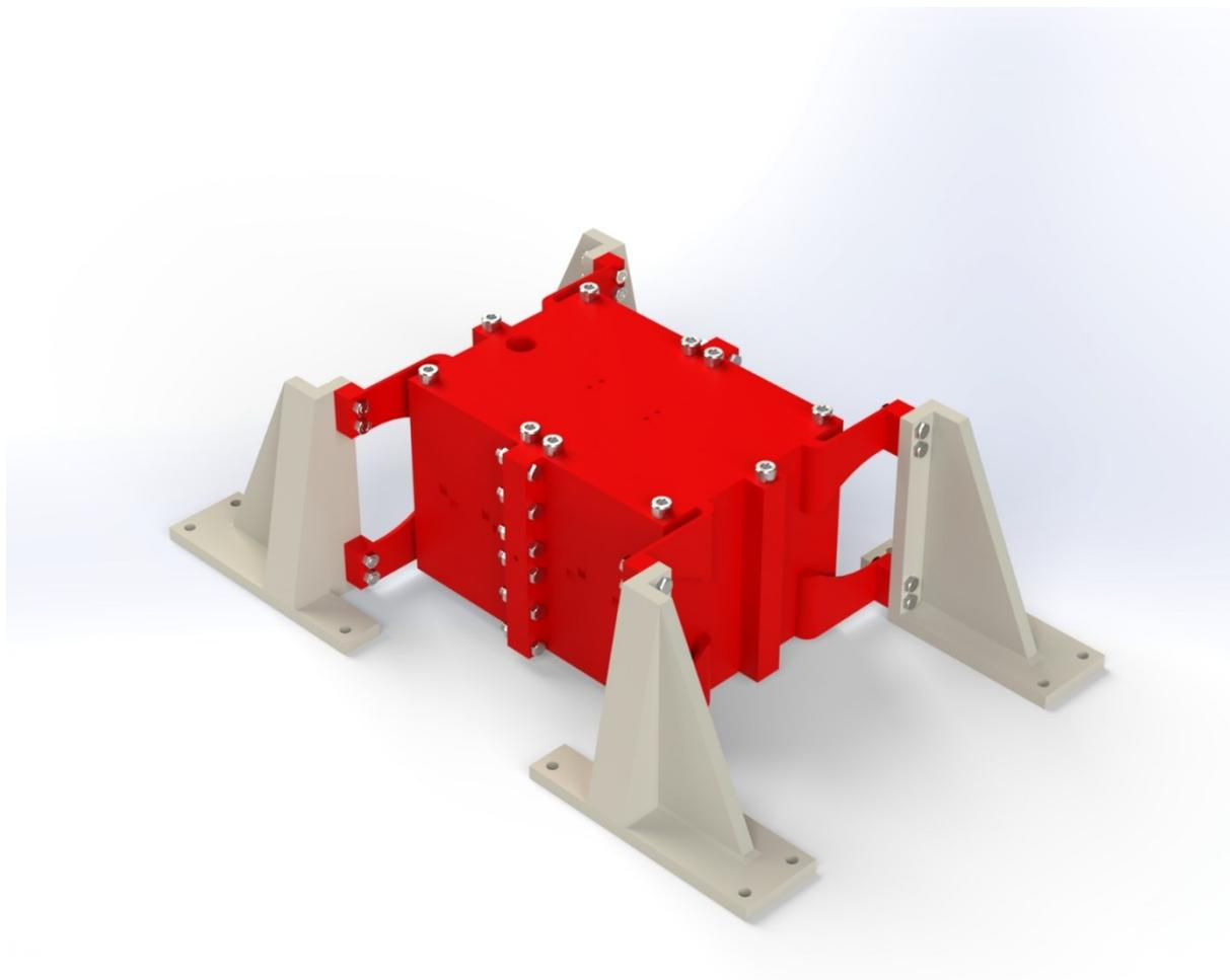
**Slika 4.5 Sklop primarne strukture sa integriranim uređajem za žetvu vibracija**
