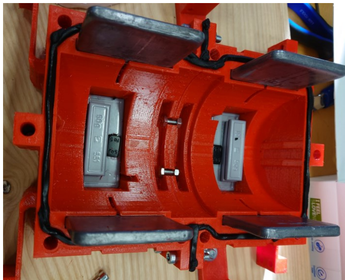
Slika 4.16 Vijčani spoj dvaju četvrtina primarne strukture
