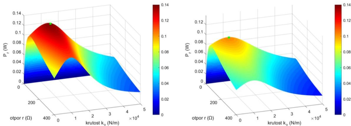
Slika 5.7 Trodimenzionalni prikaz razvijene korisne snage  $P_r$  za  $c_2 = 5$  Ns/m (lijevo) i  $c_2 = 13.5$  Ns/m (desno)
