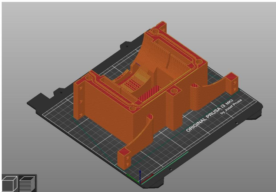
Slika 4.12 Model razložen na slojeve korištenjem softwera *PrusaSlicer*
