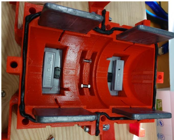
Slika 4.16 Vijčani spoj dvaju četvrtina primarne strukture
