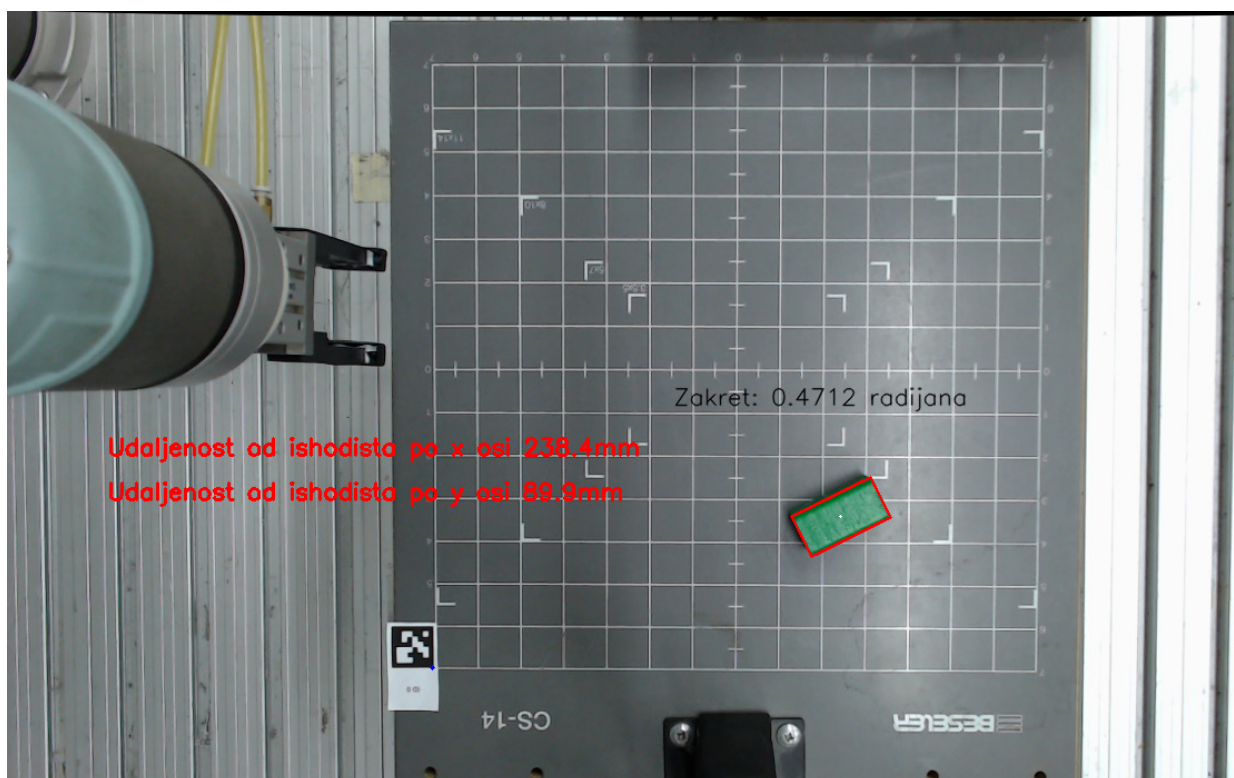
Slika 7.2. Određivanje položaja i orijentacije predmeta u radnoj okolini
