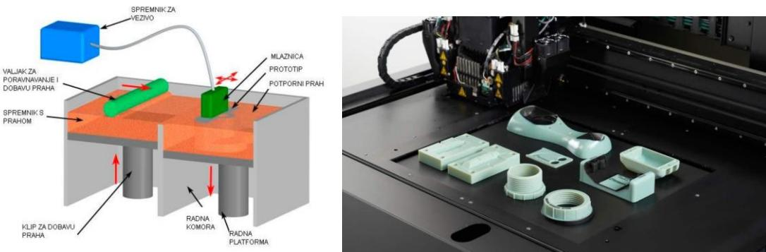
Slika 26. Shematski prikaz MJ postupka s primjerom iz prakse [39]
