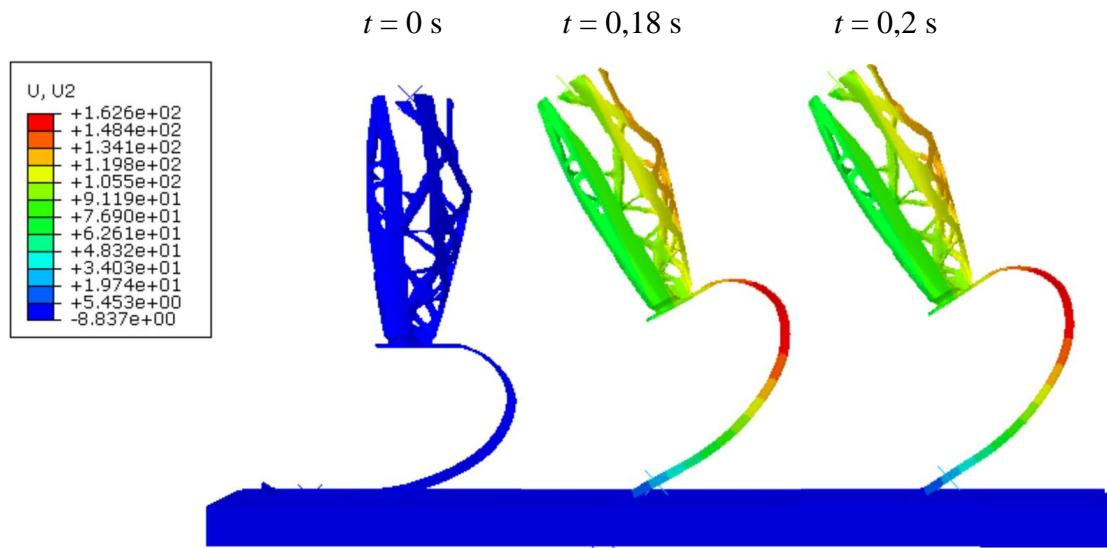
Slika 58. Vertikalni pomak proteze u ključnim trenucima [mm]
