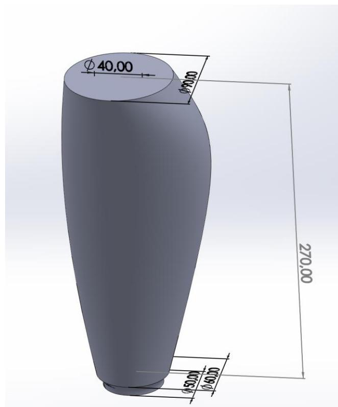
Slika 31. Osnovne dimenzije pojednostavljenje geometrije potkoljenice u [mm]
