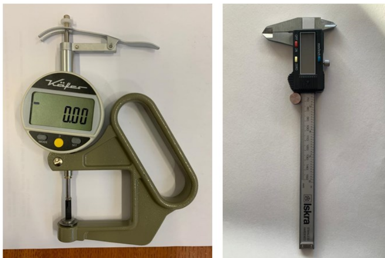
Slika 4.8 Digitalni mikrometar za mjerenje debljine (lijevo), digitalno pomično mjerilo (desno)
