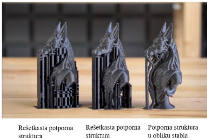
Slika 3.6 Dva osnovna oblika potporne strukture [6]
