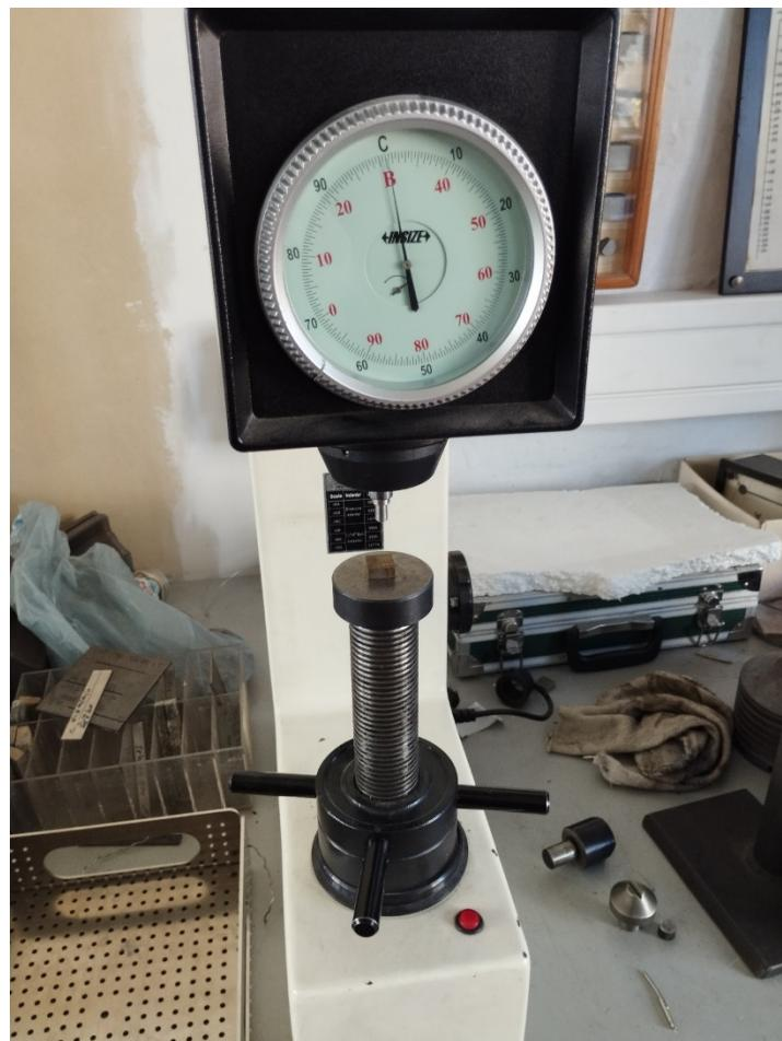
Slika 31. Određivanje adhezivnosti prevlake na Rockwell C tvrdomjeru
