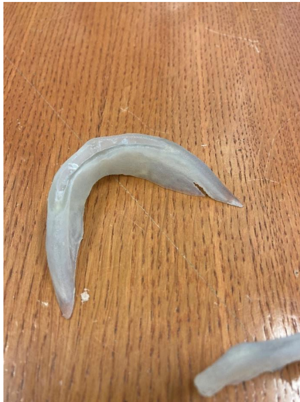
Slika 33 Prototip implantata nakon uklanjanja potporne strukture
