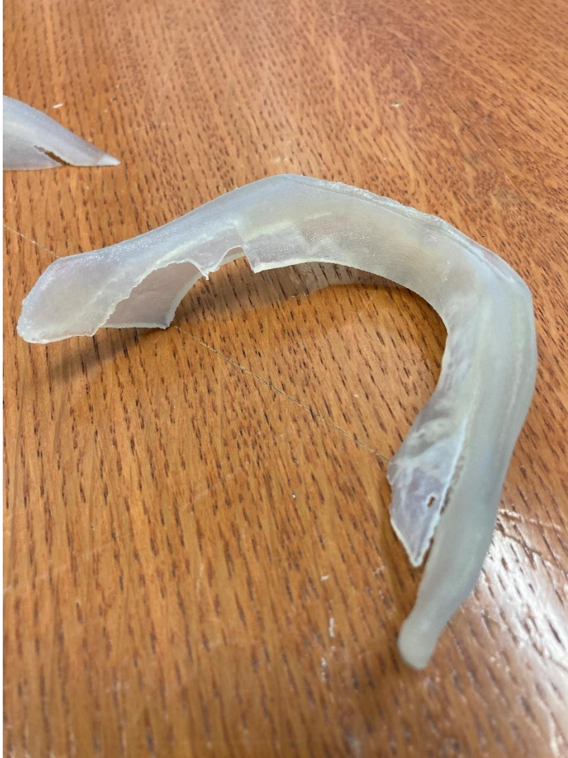
Slika 34 Prototip kirurške vodilice nakon uklanjanja potporne strukture
