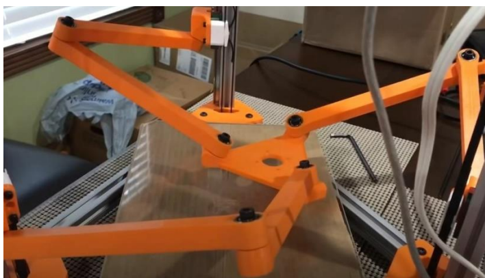
Slika 12 Primjer specijalne izvedbe FFF pisača (Tripteron) [14]
