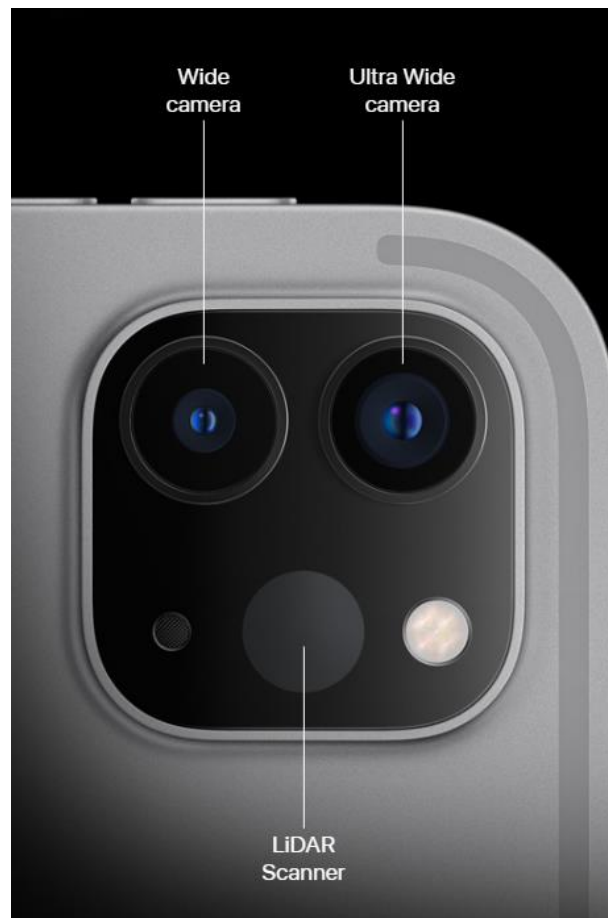
Slika 6. Sustav dvije kamere i lidara na tabletu iPad Pro [6]
