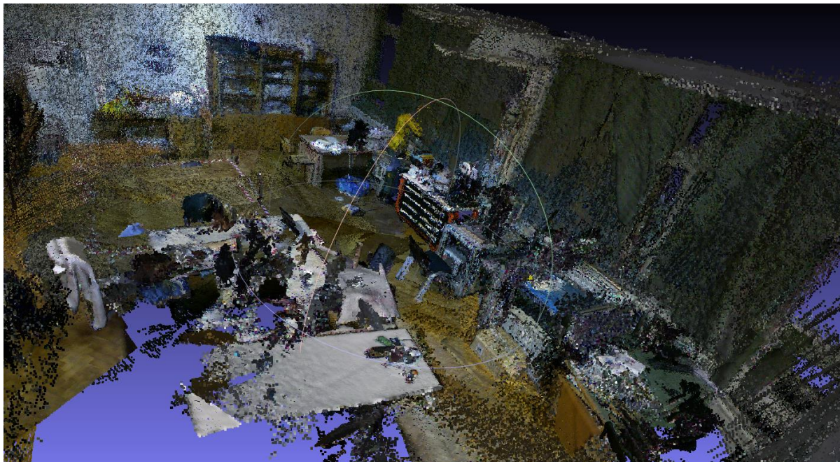
Slika 30. Pogled 2- Oblak točkica proizašao iz snimki sa kamerom Xbox360 Kinect
