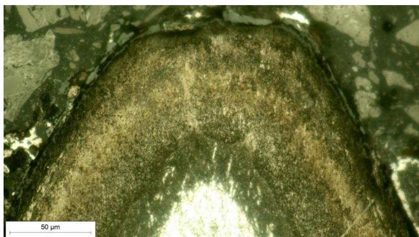
Slika 27. Vrh navoja M5, nitrokarburirano 6h, povećanje 500x
