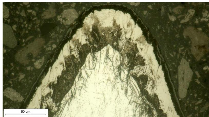
**Slika 23. Vrh navoja M3, nitrokarburirano 2h, povećanje 500x**
