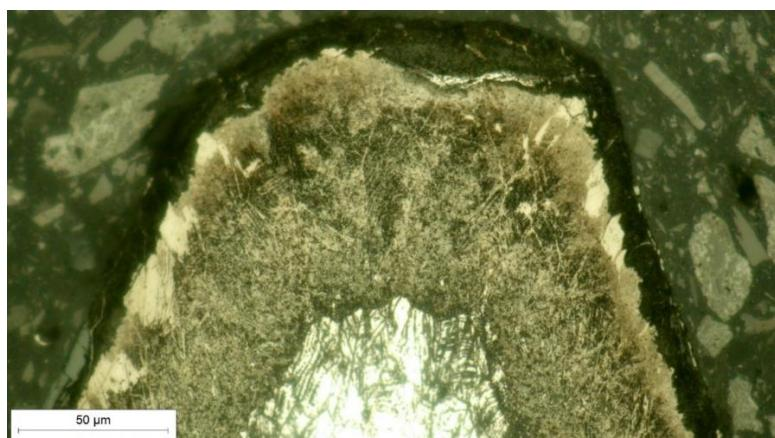
**Slika 25. Vrh navoja M4, nitrokarburirano 4h, povećanje 500x**
