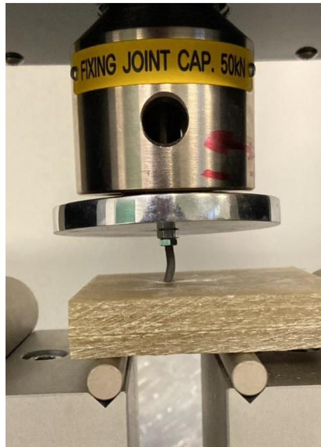
**Slika 33.** Izvijanje pri postupku određivanja sile pucanja
