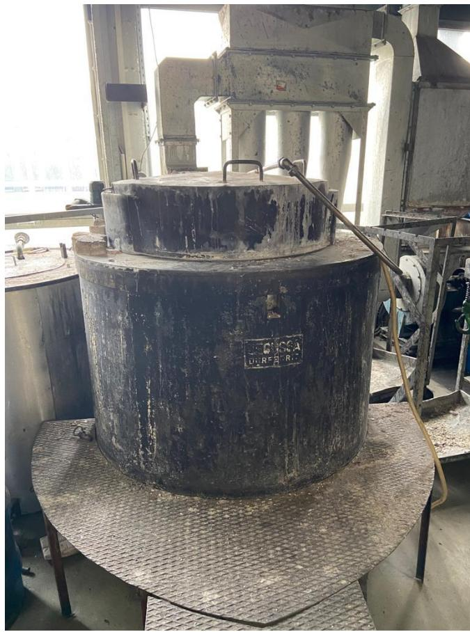
Slika 17. Solna kupka korištena za nitrokarburiranje „DURFERRIT-DEGUSSA GmbH“
