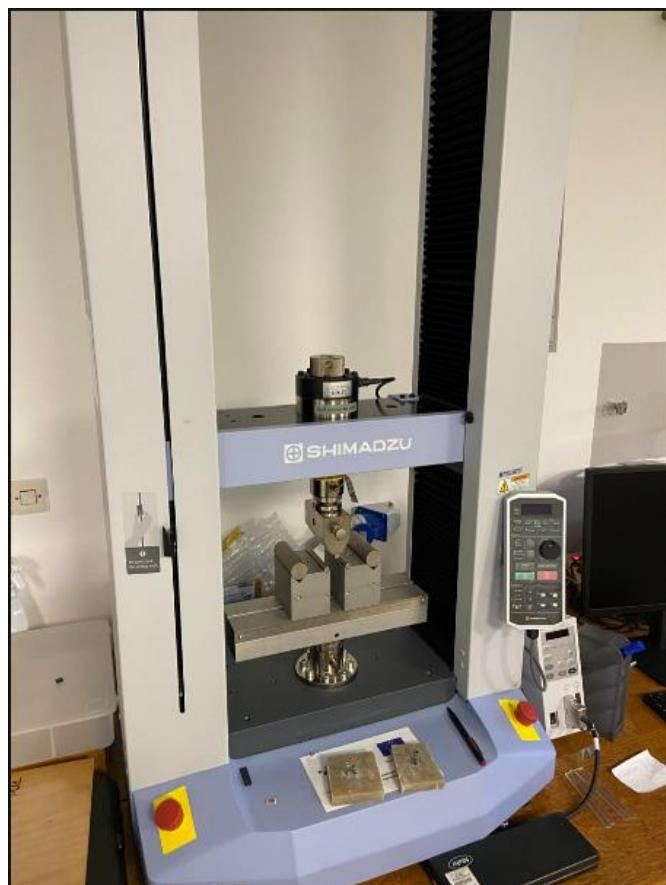
Slika 32. "SHIMADZU kidalica"
