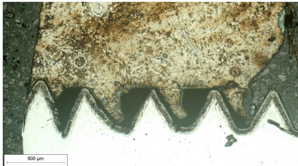
Slika 35. Prikaz puknuća navoja matice M3, nitrokarburirano 4h
