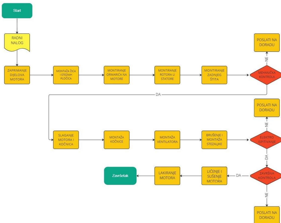
Slika 5.9 Dijagram toka za proces montaže elektromotora
