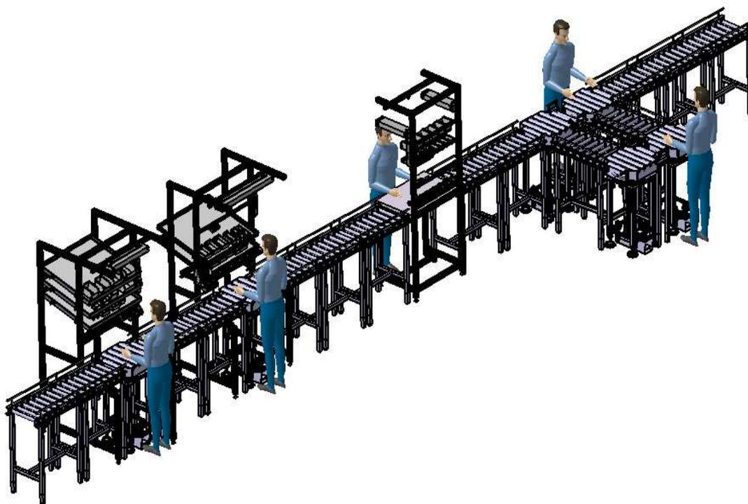
Slika 5.18 Linija za montažu elektromotora [izrada autora]
