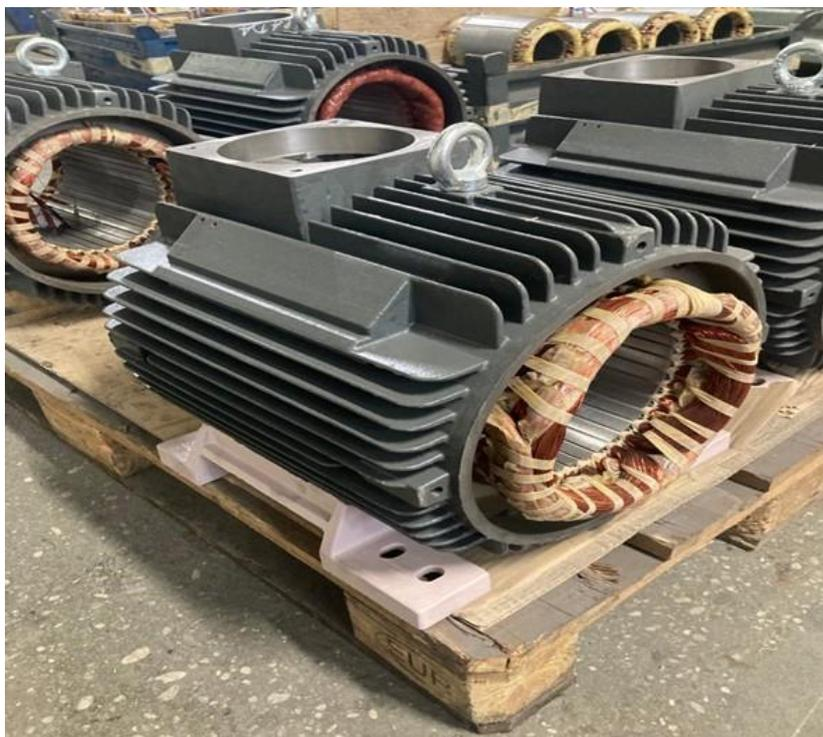
**Slika 5.5 Kočioni motor na skladištu [slika iz proizvodnog pogona]**
