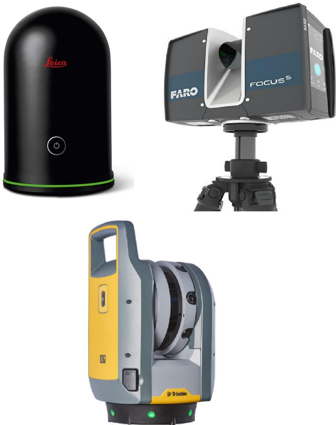
Slika 2 : Prikaz laserskih 3D skenera [2]
