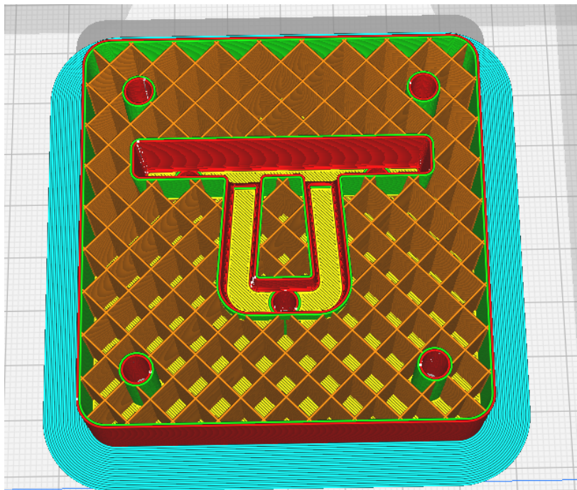
Slika 13 Presjek FDM/FFF 3D ispisa
