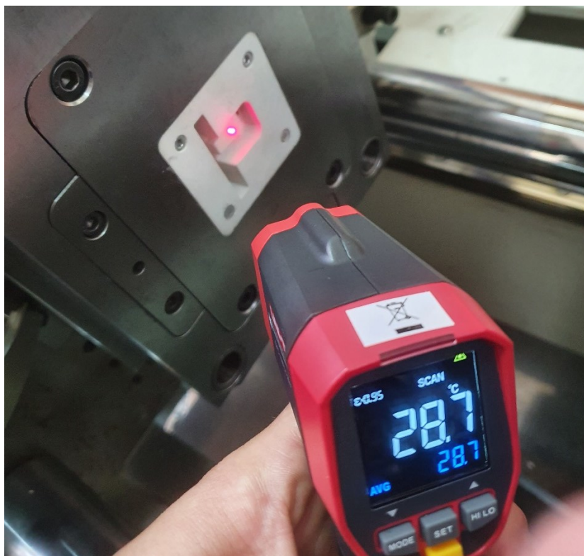
Slika 29 Mjerenje temperature prije zatvaranja kalupa
