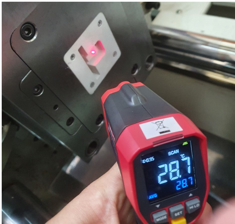
Slika 29 Mjerenje temperature prije zatvaranja kalupa
