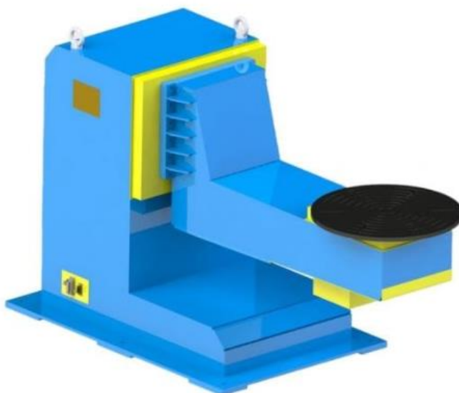
Slika 2.14. Naprava za pozicioniranje L oblika [10]
