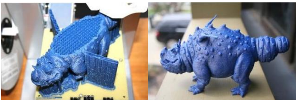
Slika 5. Primjer izrade FDM postupkom; tijekom izrade s potpornom strukturom (lijevo) i nakon izrade kada je uklonjena potporna struktura (desno) [1]
