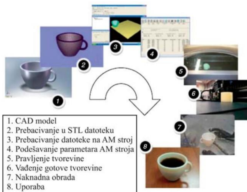
Slika 2. Faze izrade AM postupcima [2]
