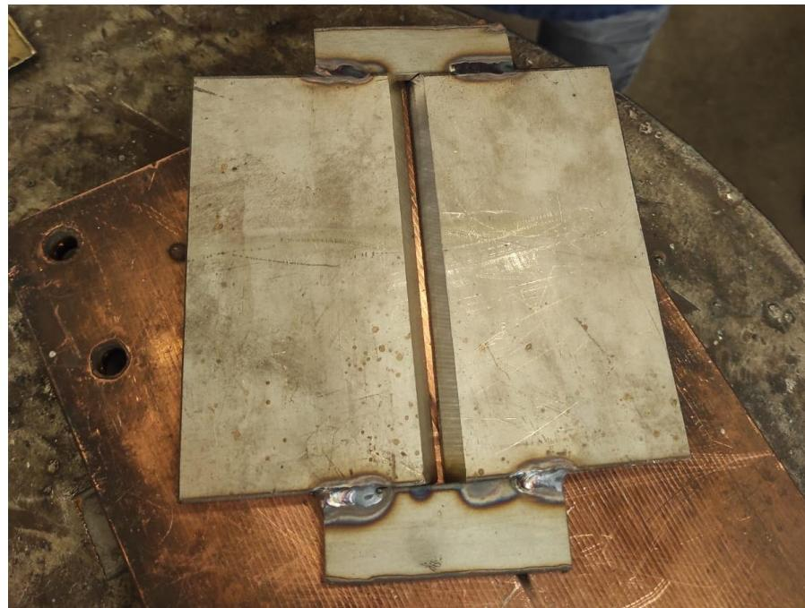
Slika 29. Uzorak s zavarenom ulaznom i izlaznom pločicom
