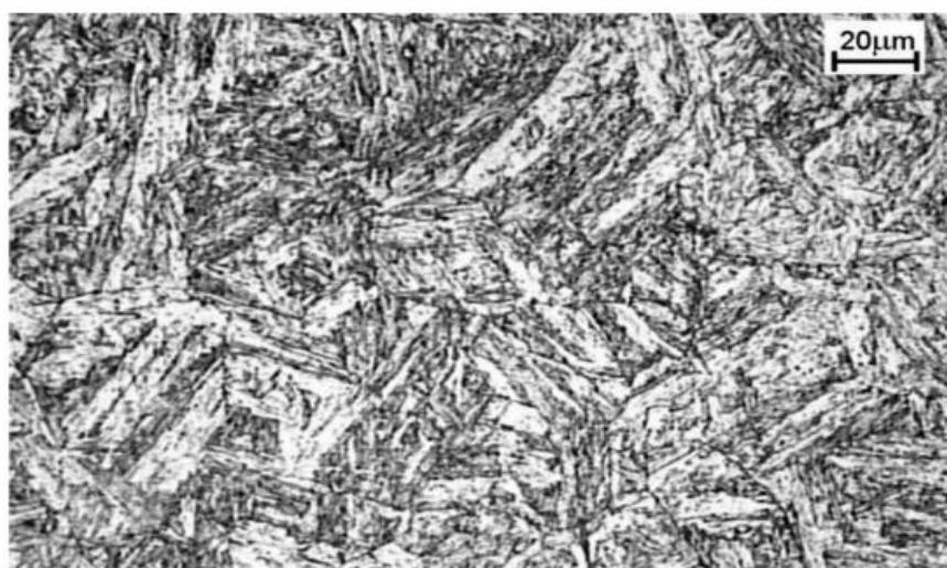
Slika 20. Mikrostruktura martenzitnog nehrđajućeg čelika [21]
