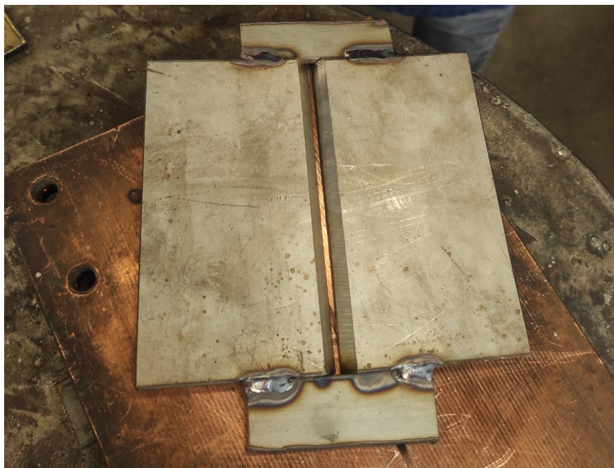
Slika 29. Uzorak s zavarenom ulaznom i izlaznom pločicom
