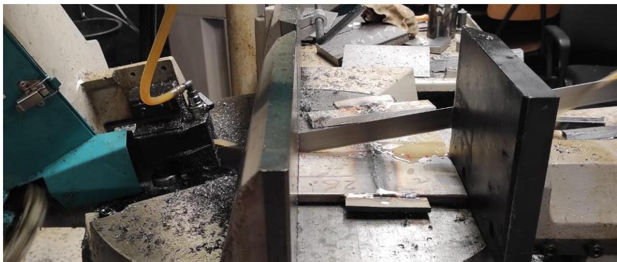
Slika 69. Rezanje uzoraka na tračnoj pili
