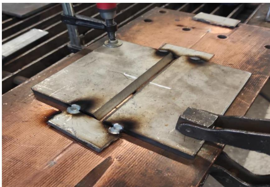
Slika 35. Priprema spoja kod MIG uzorka
