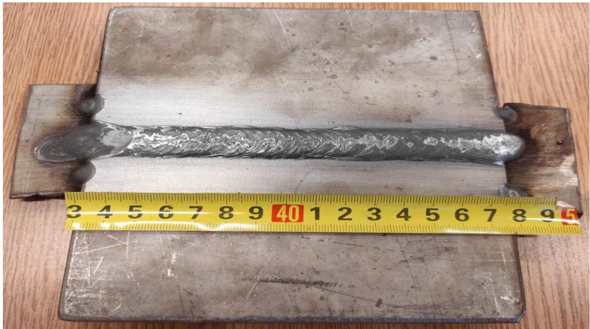
Slika 38. Izgled gornje površine i lica zavara MIG uzorka
