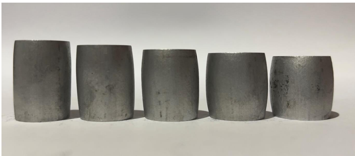
Slika 27. Cilindrični uzorci nakon sabijanja batom, legura AlCuBiPb
