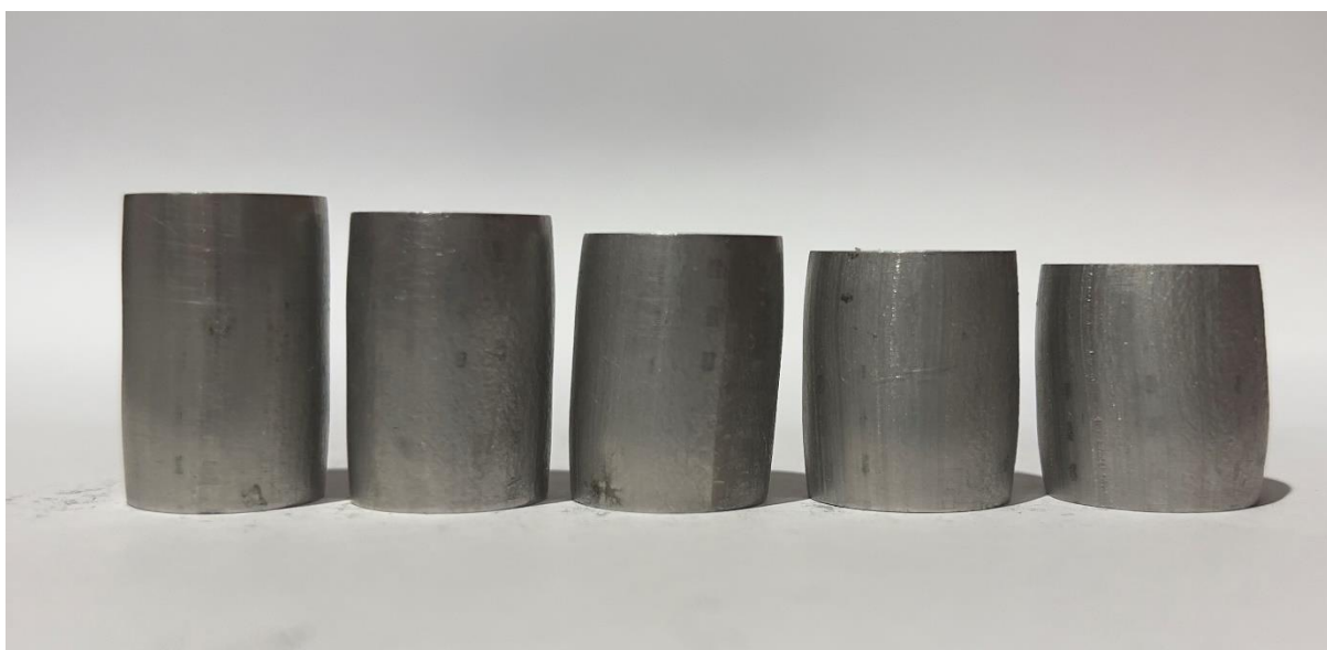
Slika 24. Cilindrični uzorci nakon sabijanja batom, legura AlMgSi1
