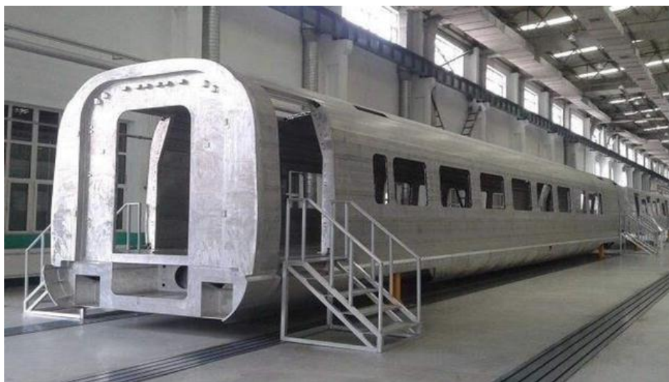
Slika 33. Tipična karoserija brzih vlakova izrađena od aluminijske legure [24]
