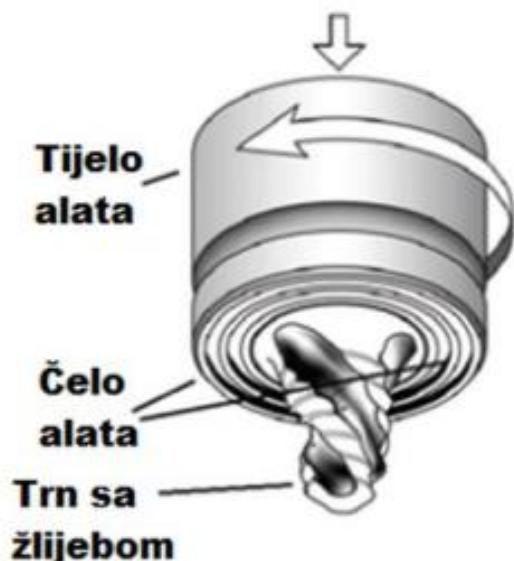
**Slika 19. Alat za zavarivanje trenjem MX Triflute™[3]**
