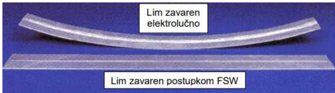
Slika 25. Savijanje limova zavarenih elektrolučno i FSW postupkom[14]
