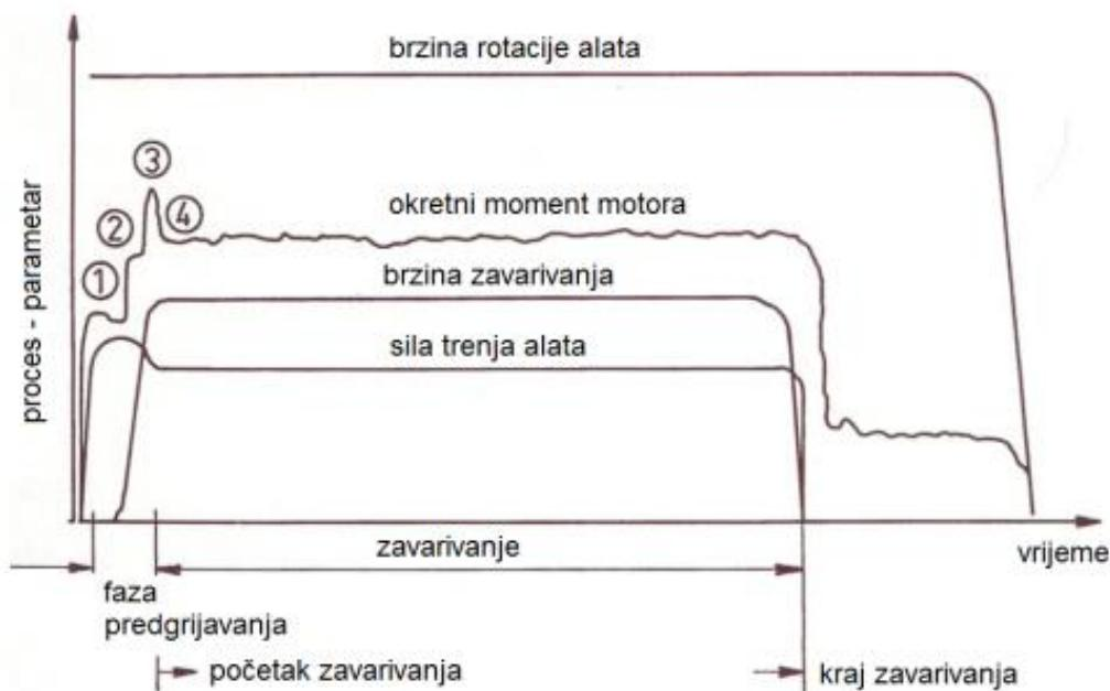
Slika 8. Dijagram promjene parametara kod FSW zavarivanja[11]:
