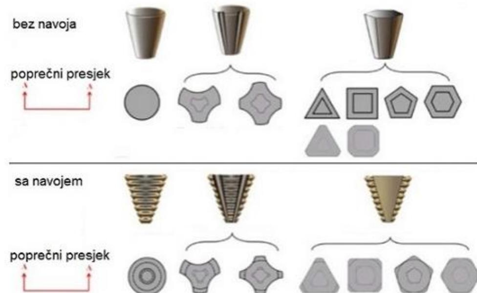
**Slika 17. Oblici konusnih trnova sa i bez urezanog navoja na bočnoj površini [18]**
