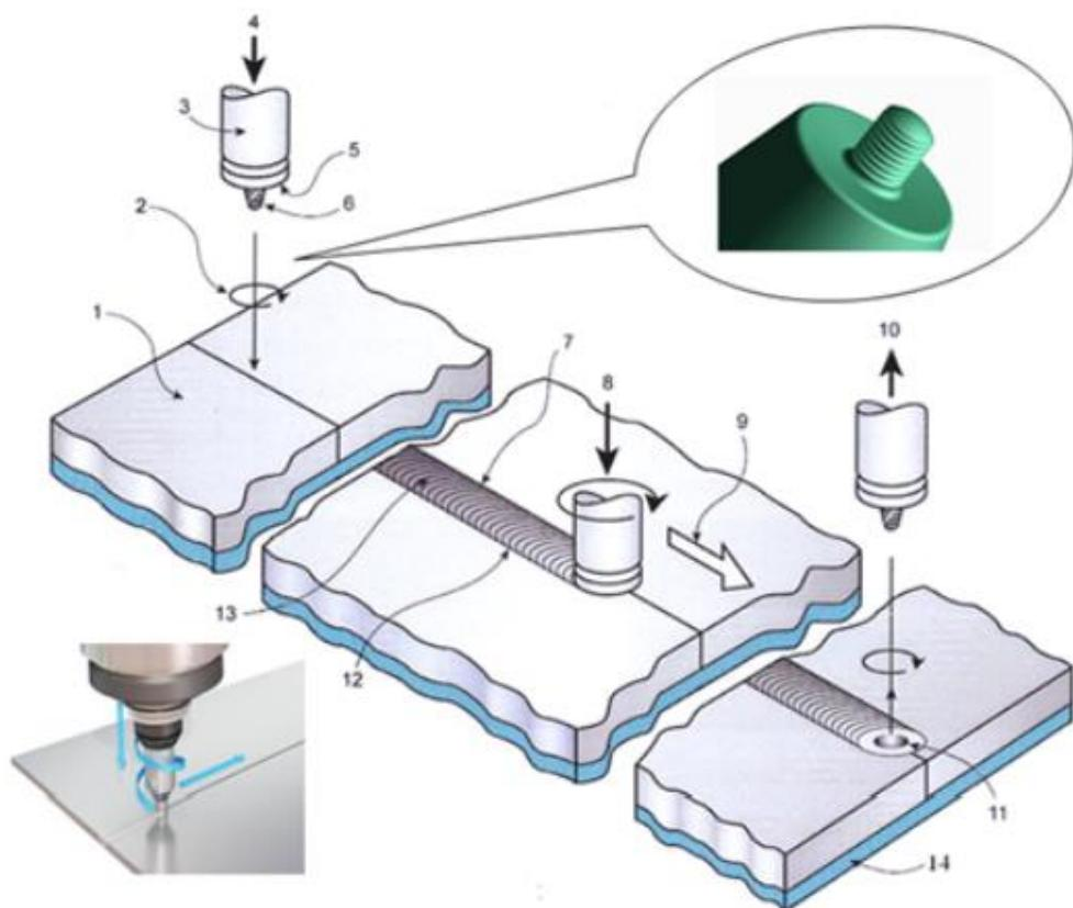
**Slika 4. Shematski prikaz zavarivanja trenjem uz miješanje[4]**
