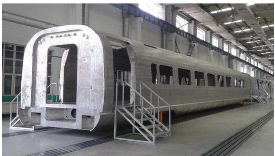
**Slika 33.Tipična karoserija brzih vlakova izrađena od aluminijске legure[24]**
