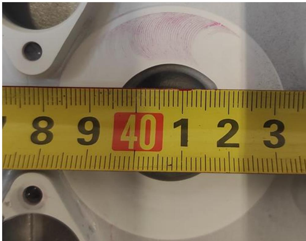
Slika 40. Zavar nakon ispitivanja penetrantom
