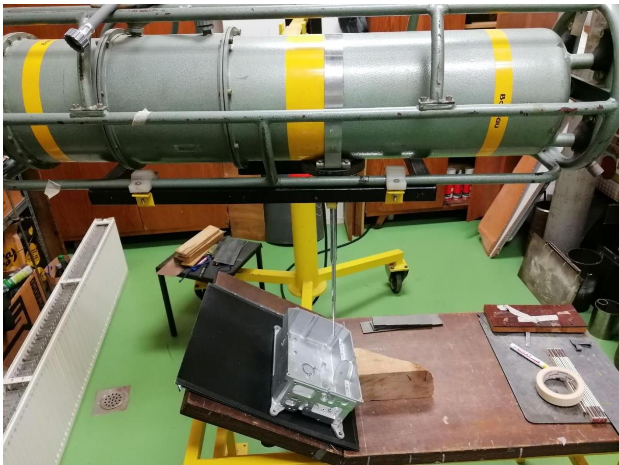
**Slika 43. Postupak radiografskog ispitivanja pomoću RTG uređaja Balteau 300D**
