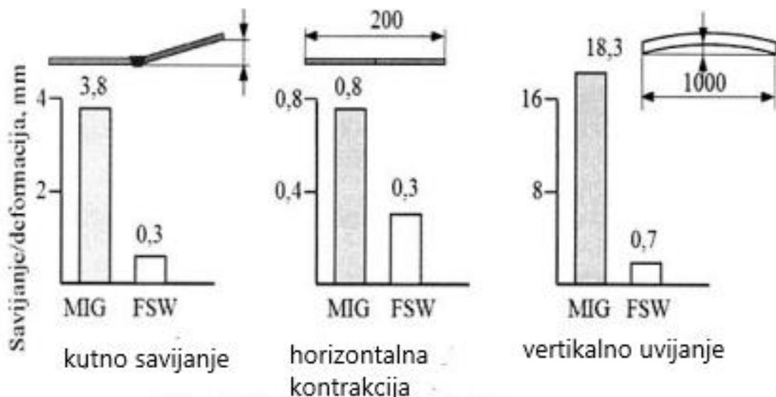
Slika 26. Dijagrami deformacija pri FSW i MIG zavarivanju[3]
