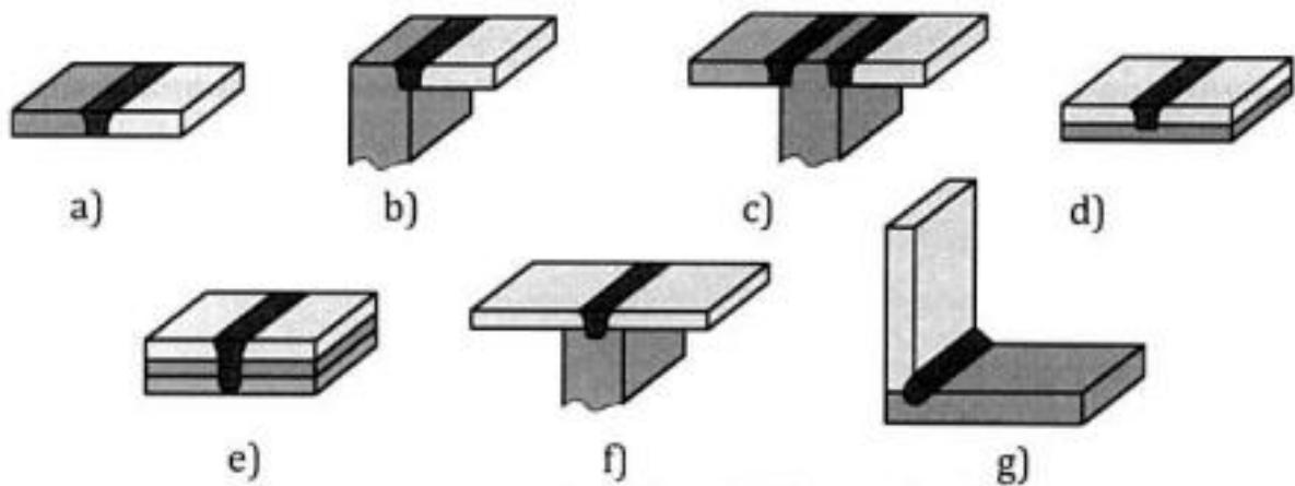
**Slika 24. Različiti oblici zavarenih spojeva zavarenih FSW postupkom[3]**
