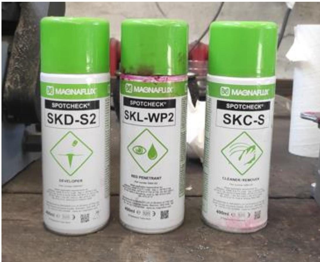
**Slika 37. Penetrant, odstranjivač, razvijač korišteni u eksperimentu**
