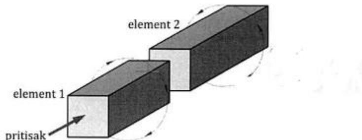
**Slika 3.Zavarivanje elemenata kvadratnog poprečnog presjeka[3]**
