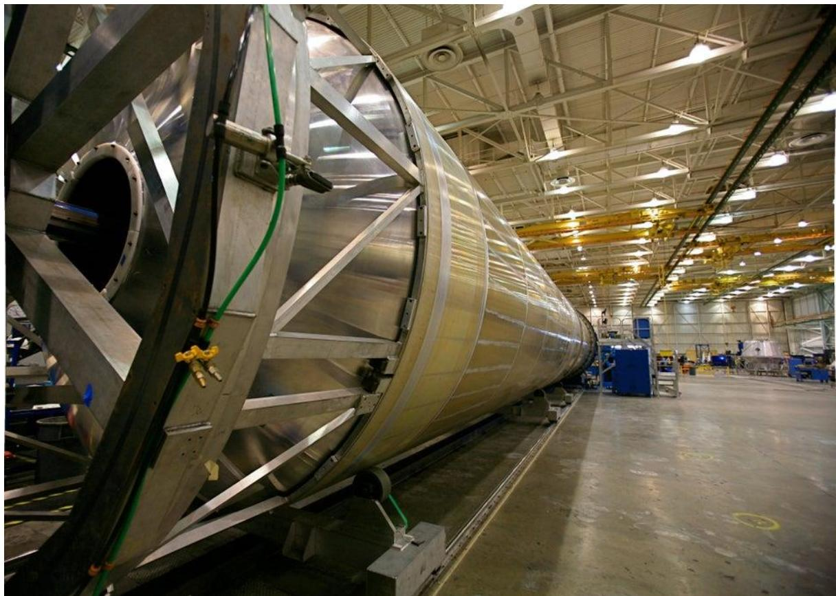
**Slika 30. Uzdužni i kružni zavareni spojevi na raketni Falcon 9 SpaceX[24]**
