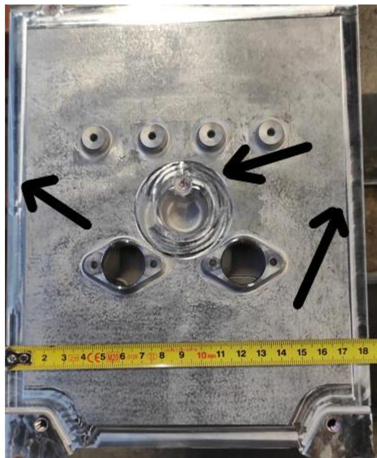
Slika 36. FSW zavareni spojevi na obratku
