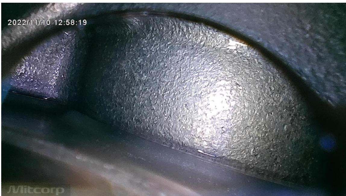
Slika 48. Slika zavara pomoću videoskopa
