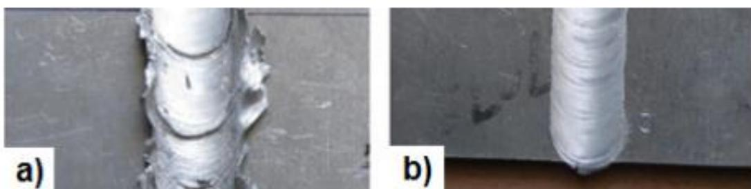
**Slika 10. Lica zavara aluminijskih legura AA2014-T651 i AA6063-T651 zavarene s različitim nagibom alata[15]**
