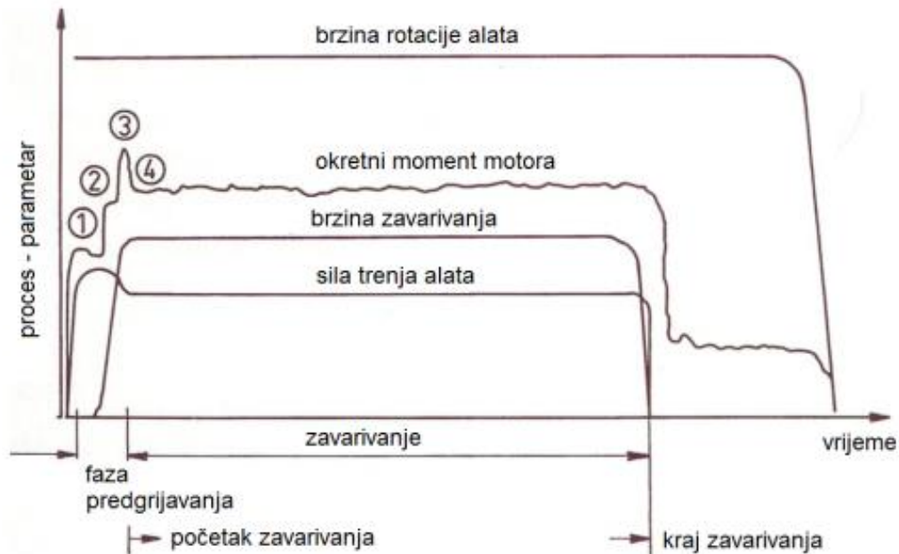
Slika 8. Dijagram promjene parametara kod FSW zavarivanja[11]:
