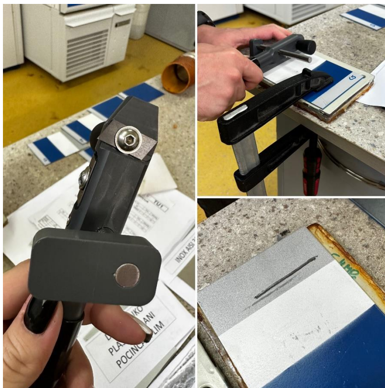
Slika 36. Postupak izrade ureza prije slane komore
