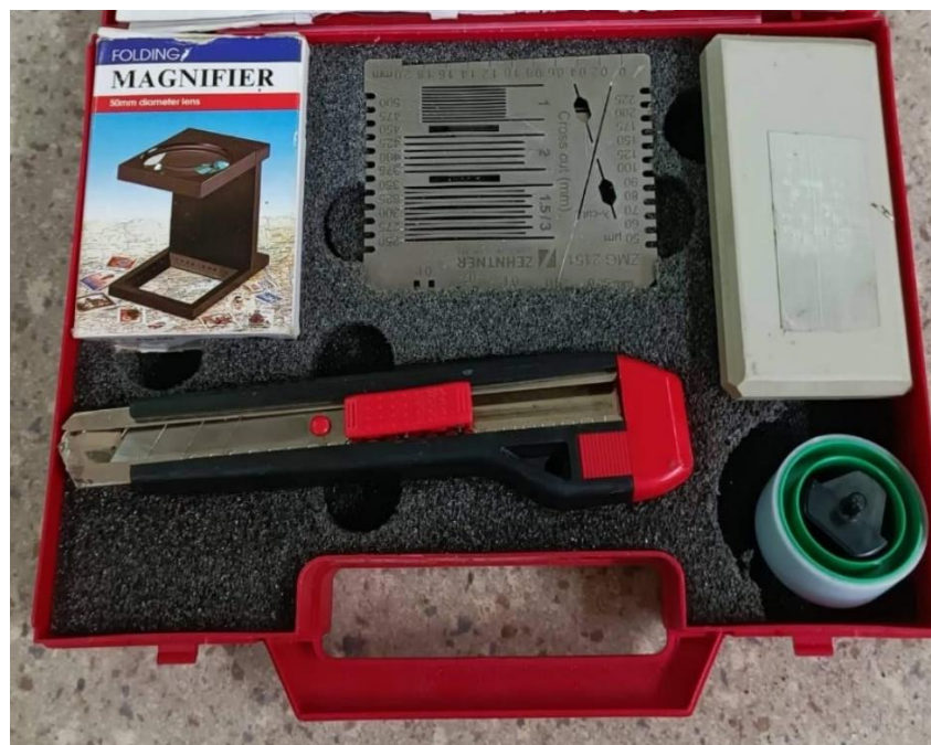
Slika 25. Set za ispitivanje prionjivosti urezivanjem mrežice
