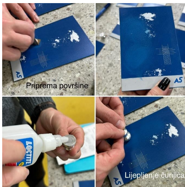
Slika 30. Postupak pripreme površine i lijepljenja valjčića za „Pull-off“ test
