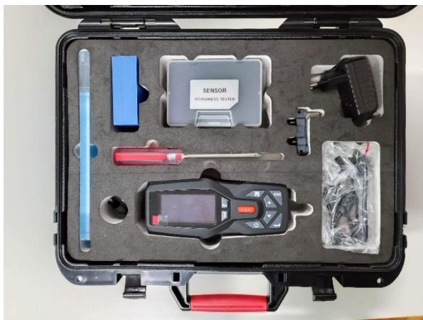
Slika 19. Uređaj za mjerenje hrapavosti površine
