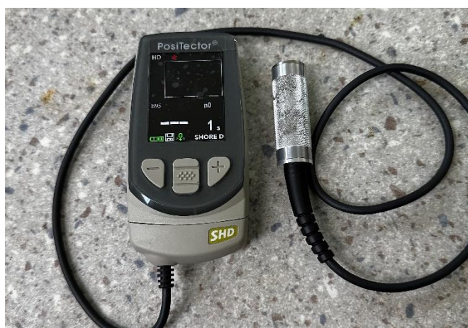
Slika 32. Uređaj za mjerenje tvrdoće, Shore D metoda
