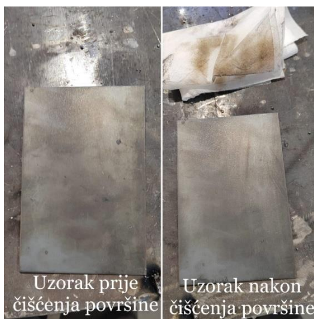
Slika 18. Čišćenje površine ispitnih uzoraka
