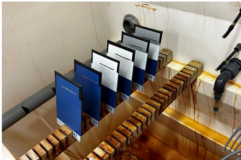
Slika 37. Ispitni uzorci u slanoj komori
