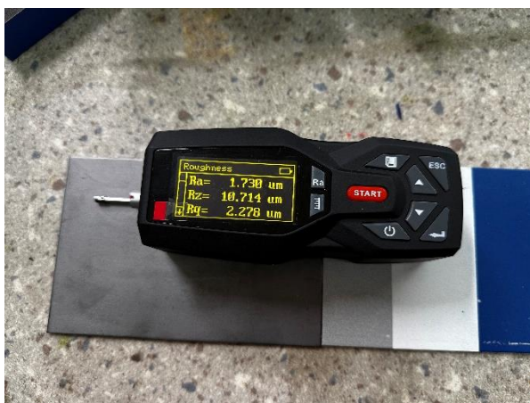
Slika 20. Mjerenje hrapavosti ispitnog uzorka
