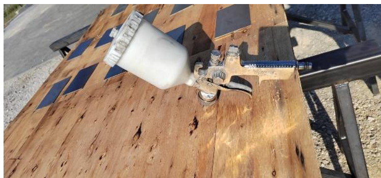
Slika 21. Valeo pištolj za nanošenje premaza
