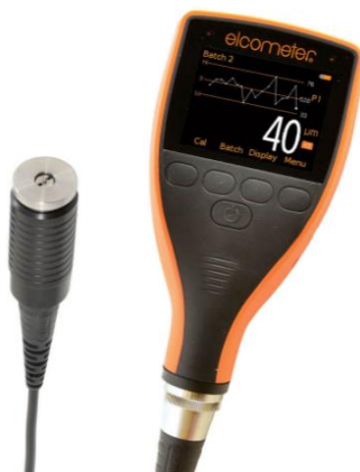
Slika 24. Elcometer 456 – uređaj za mjerenje debljine suhog filma
