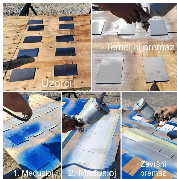
Slika 22. Nanošenje premaza na ispitne uzorke
