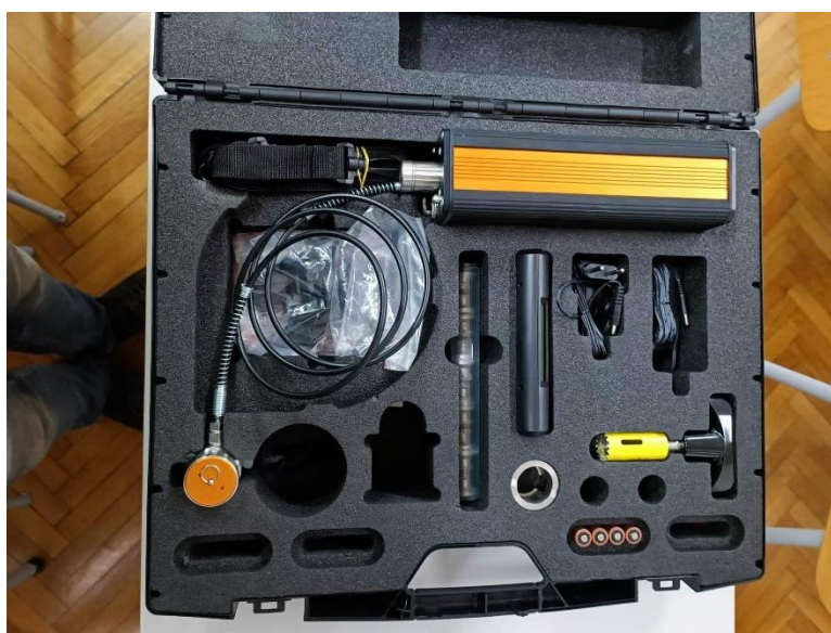
Slika 29. Set za ispitivanje prionjivosti vlačnom metodom, Elcometer 510 Model T
