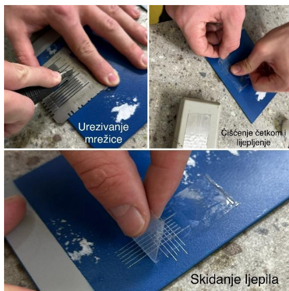
Slika 28. Postupak „Cross cut“ testa
