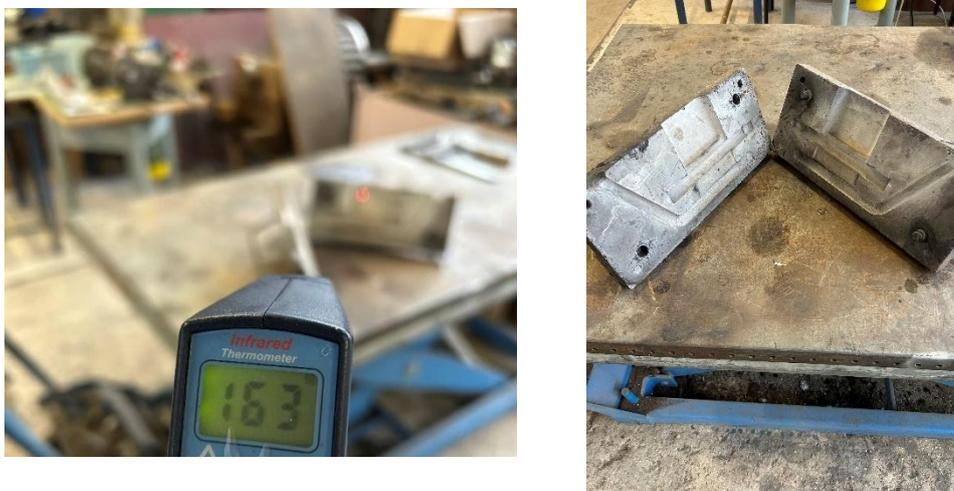
**Slika 39 Temperatura trajnog kalupa prije ulijevanja**
