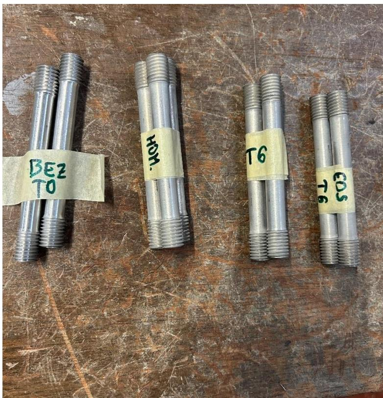
Slika 43 Epruvete izrađene aditivnom proizvodnjom
