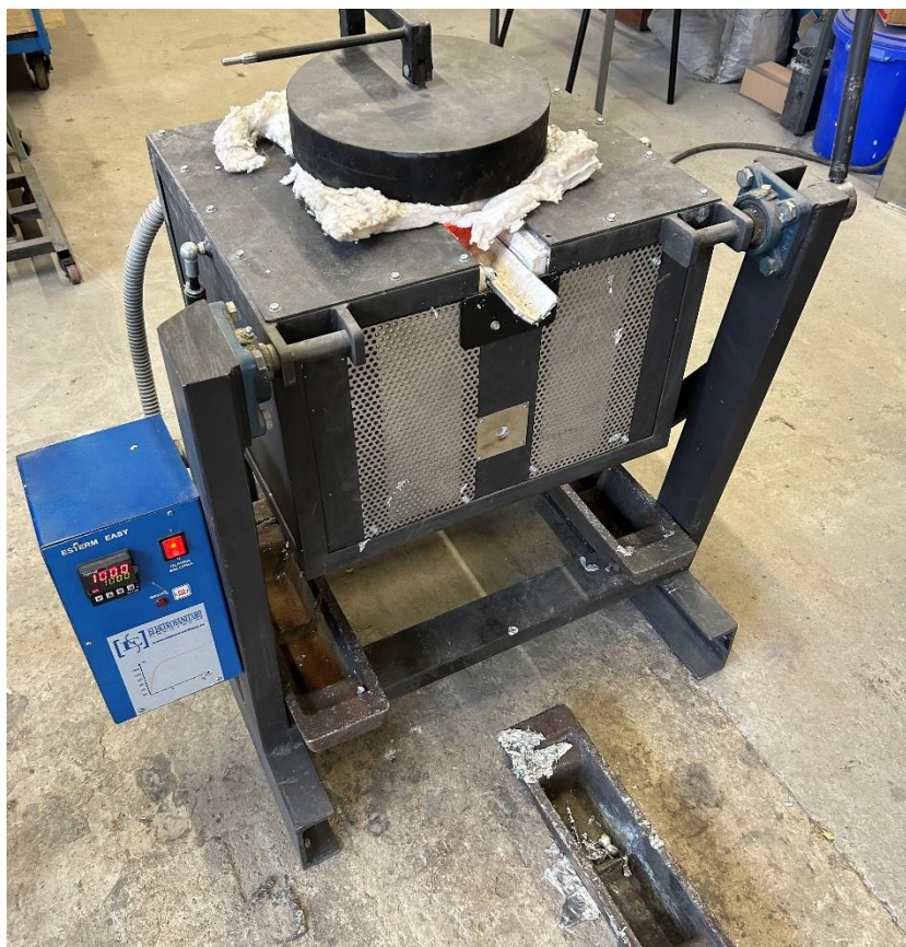
Slika 36 Peć korištena u eksperimentalnom dijelu rada za taljenja aluminijske legure
