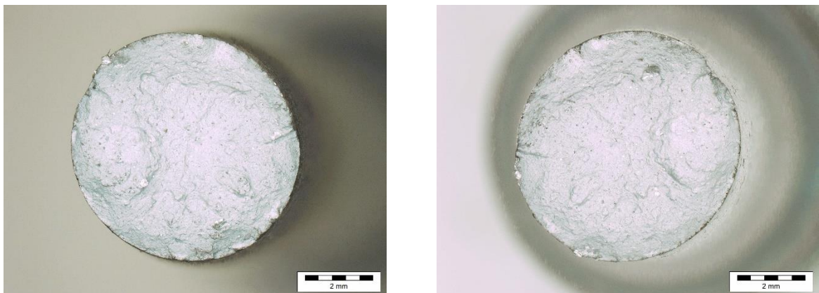
Slika 57 Prijelom SLM EOS T6 toplinski obrađene epruvete 2
