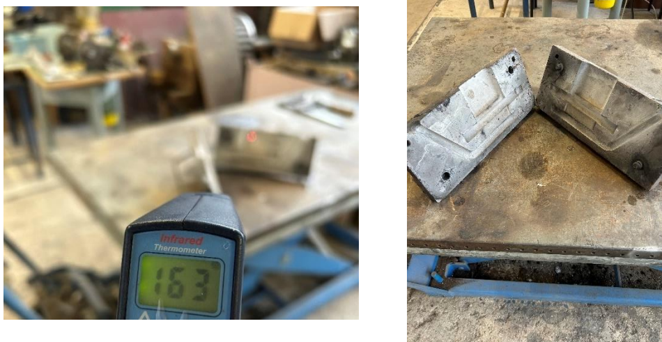
Slika 39 Temperatura trajnog kalupa prije ulijevanja
