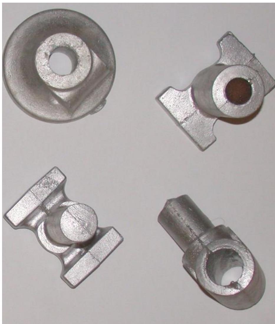
Slika 13 Aluminijski odljevci manjih masa [6]
