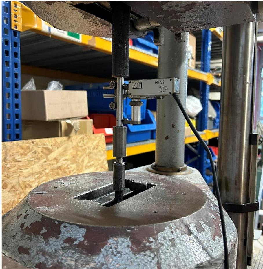
**Slika 44 Epruveta u kidalici s ekstenziometrom**
