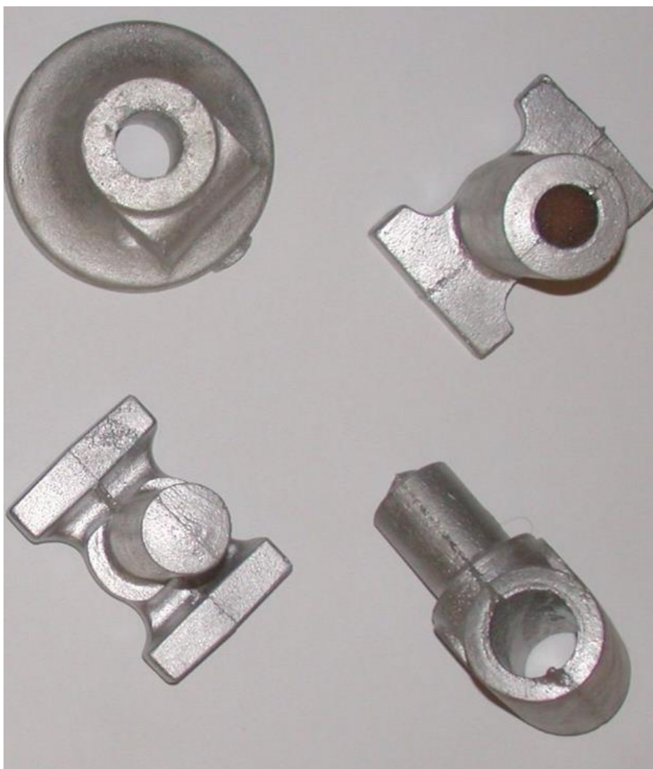
Slika 13 Aluminijski odljevci manjih masa [6]
