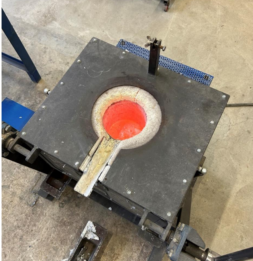
Slika 37 Taljenje aluminijske legure u peći
