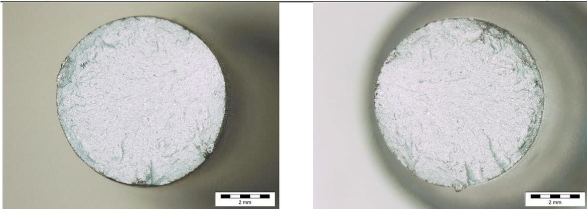
**Slika 56 Prijelom SLM T6 toplinski obrađene epruvete 2**
