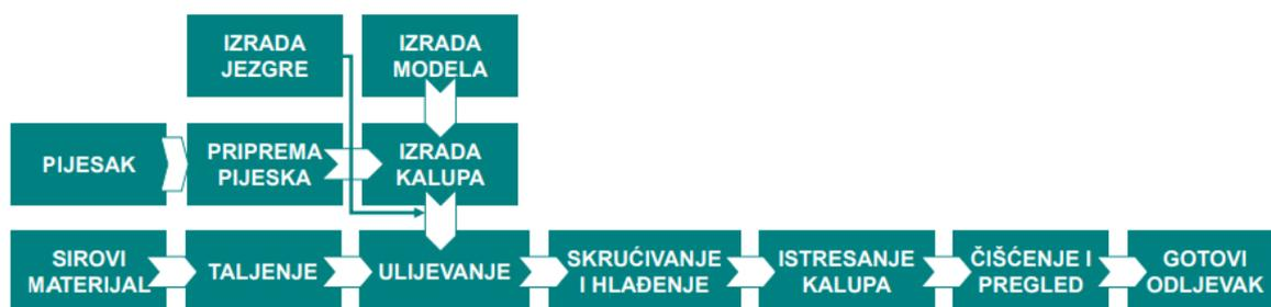
Slika 4 Shematski prikaz lijevanja u pješčane kalupe u ljevaonici [5]
