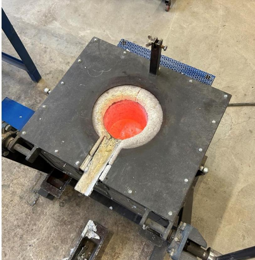
**Slika 37 Taljenje aluminijske legure u peći**
