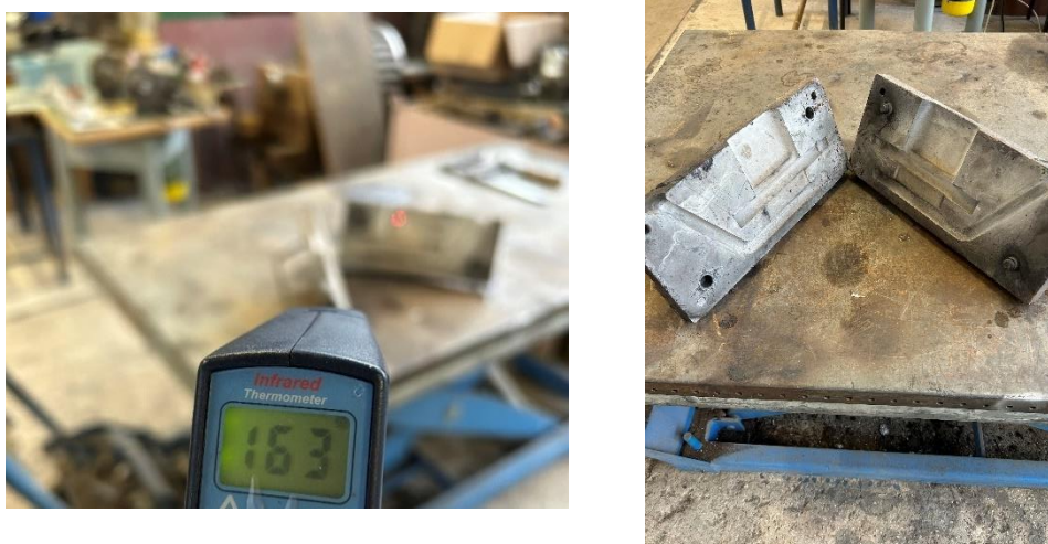
Slika 39 Temperatura trajnog kalupa prije ulijevanja
