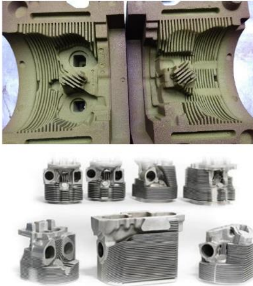
Slika 6 Aluminijski avionski cilindar izrađen školjkastim lijevanjem [8]
