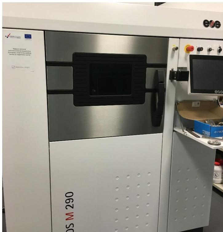
**Slika 41 Laserski 3D printer za metal EOS M 290**
