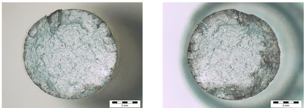
Slika 55 Prijelom SLM toplinski neobrađene epruvete 1
