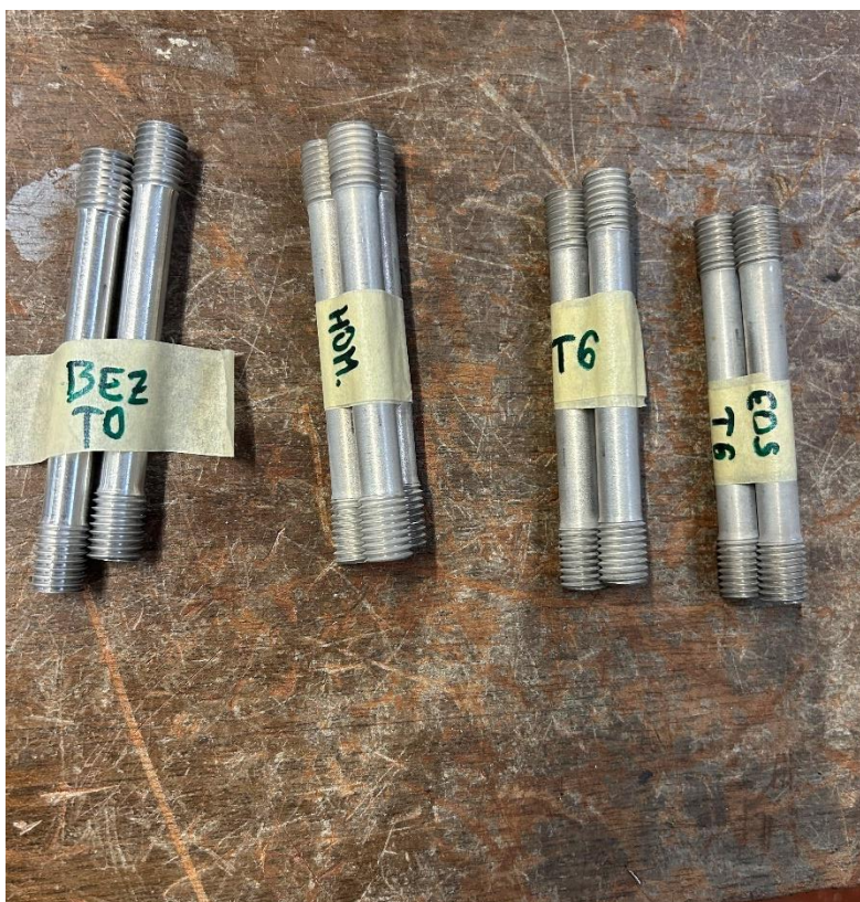
Slika 43 Epruvete izrađene aditivnom proizvodnjom
