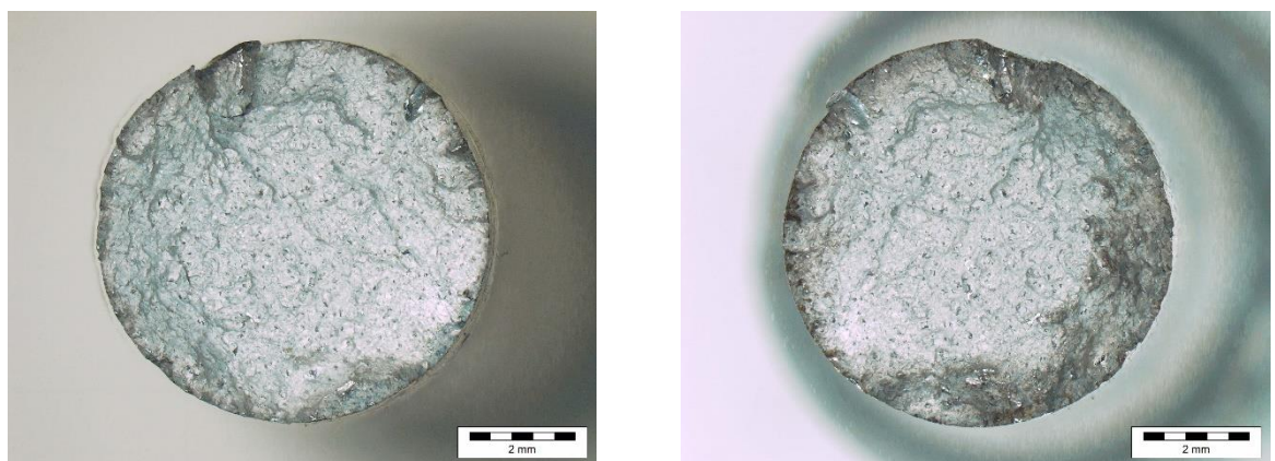
Slika 55 Prijelom SLM toplinski neobrađene epruvete 1
