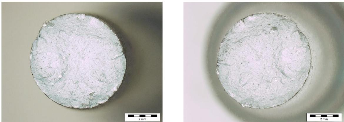
**Slika 57 Prijelom SLM EOS T6 toplinski obrađene epruvete 2**
