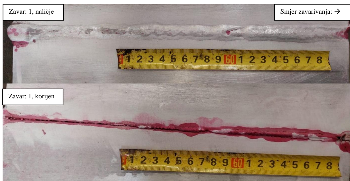
Slika 38. Rezultat ispitivanja penetrantima, uzorak 1
