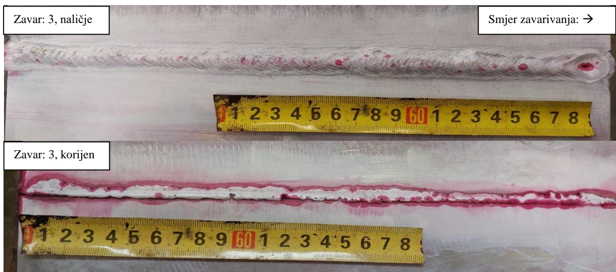
Slika 40. Rezultat ispitivanja penetrantima, uzorak 3
