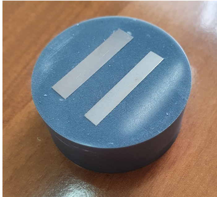
Slika 18. Uzorci u nagriženom stanju
