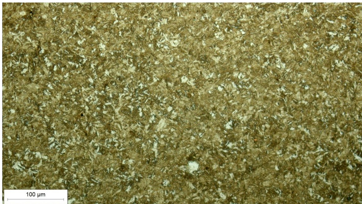
Slika 25. Mikrostruktura čelika XAR 450, snimljeno pri povećanju od 200×
