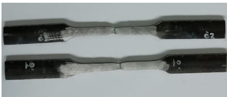
Slika 8.20 Izgled ispitnih uzoraka nakon ispitivanja vlačne čvrstoće
