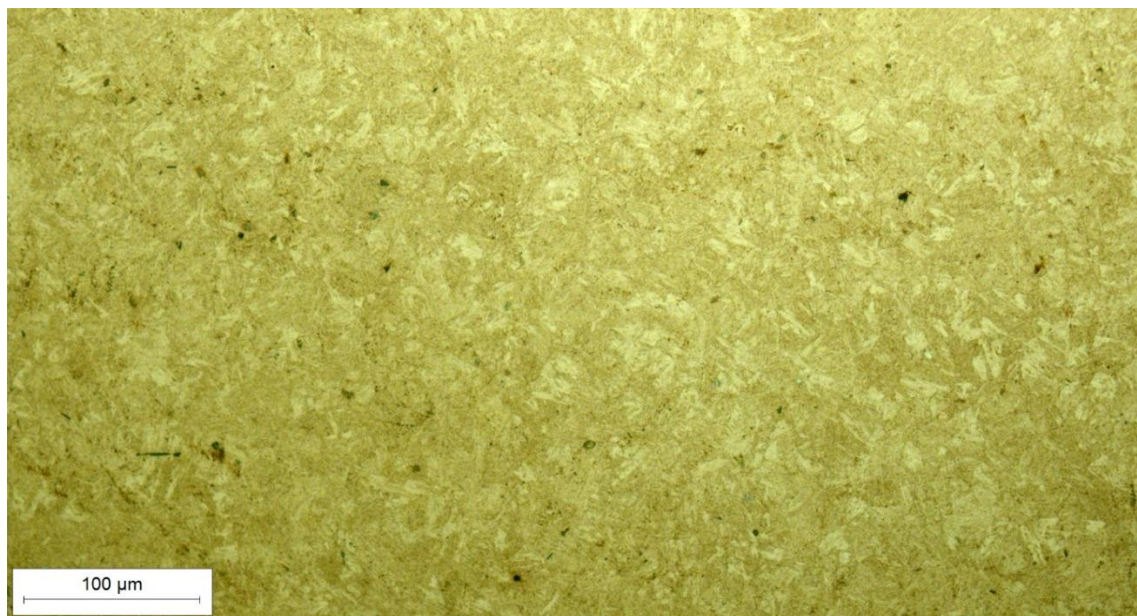
Slika 8.27 Mikrostruktura osnovnog materijala, snimljena pri povećanju 200\times
