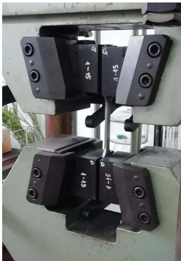
Slika 8.19 Ispitni uzorak postavljen u čeljust kidalice
