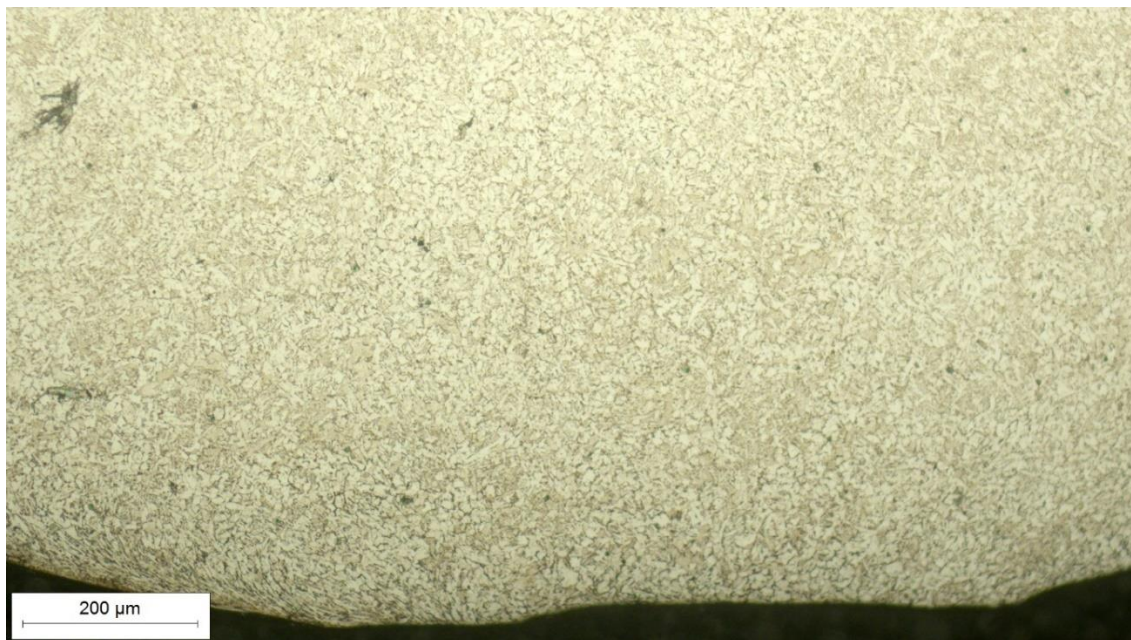
Slika 8.33 Mikrostruktura korijena zavara, snimljena pri povećanju 100×
