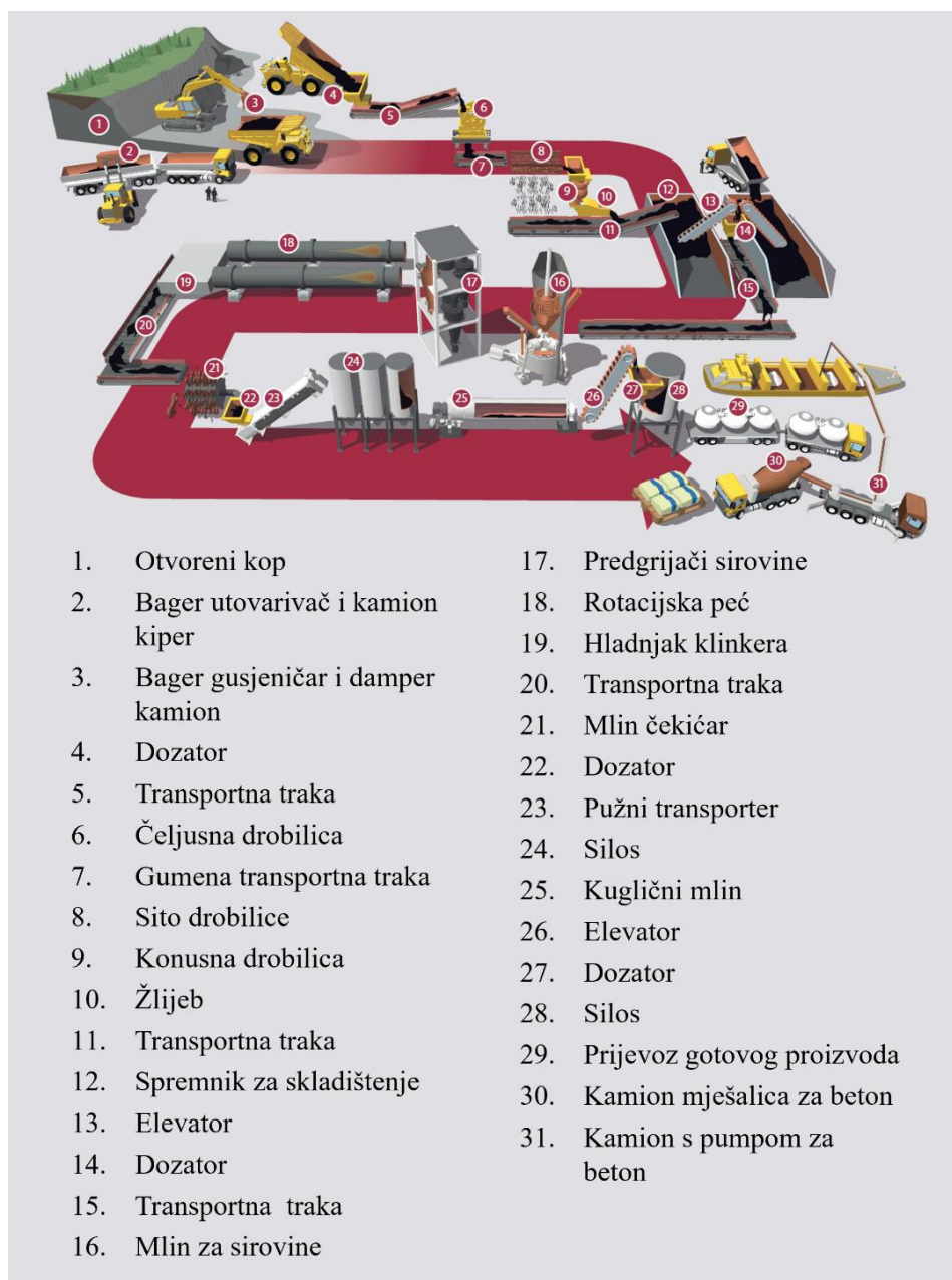
Slika 4.5 Primjena Hardox čelika u proizvodnji cementa [20]
