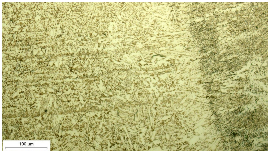
Slika 8.38 Mikrostruktura ZUT-a s lijeve strane sredine metala zavora, snimljena pri povećanju 200×
