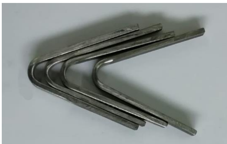
Slika 8.41 Izgled ispitnih uzoraka nakon savijanja
