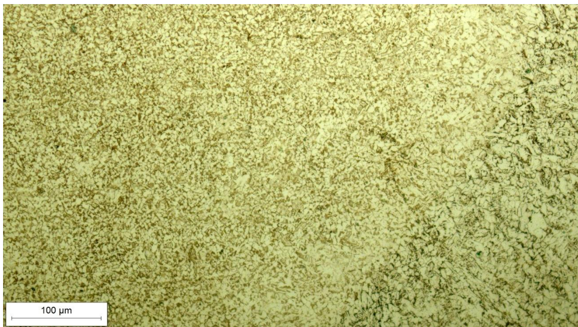
Slika 8.40 Mikrostruktura ZUT-a s lijeve strane korijena zavora, snimljena pri povećanju 200×
