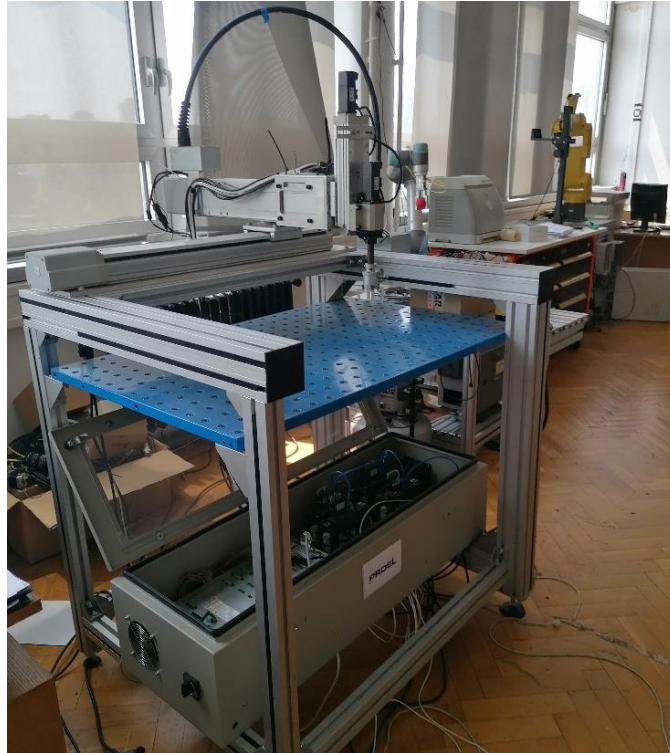
Slika 3.1.2 – Prikaz cijelog kartezijskog koordinatnog robota
