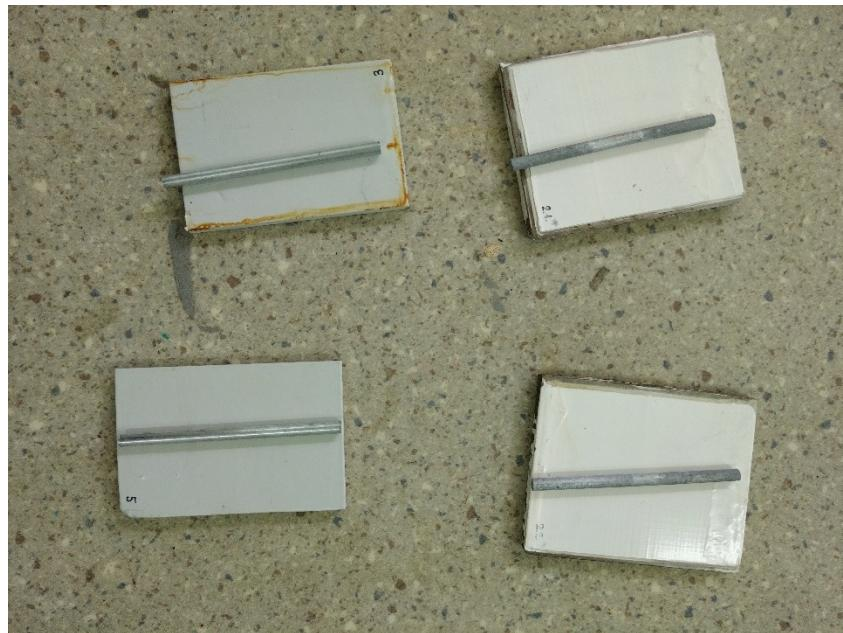
**Slika 36. Ispitivani uzorci s pripadajućim cinkovim anodama**
