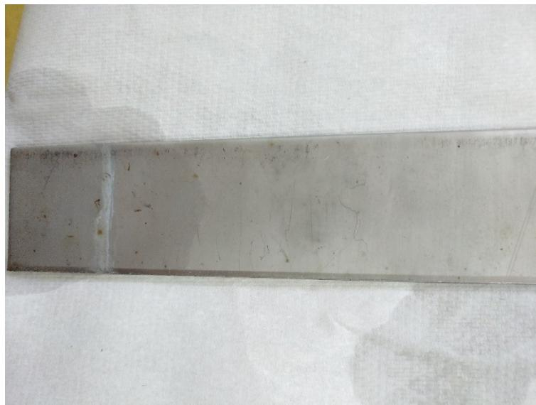
**Slika 37. Trajna anoda nehrđajućeg čelika za ispitivanje narinutom strujom**
