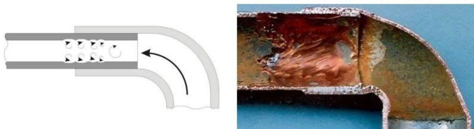
**Slika 7. Djelovanje erozijske korozije na materijal [3]**
