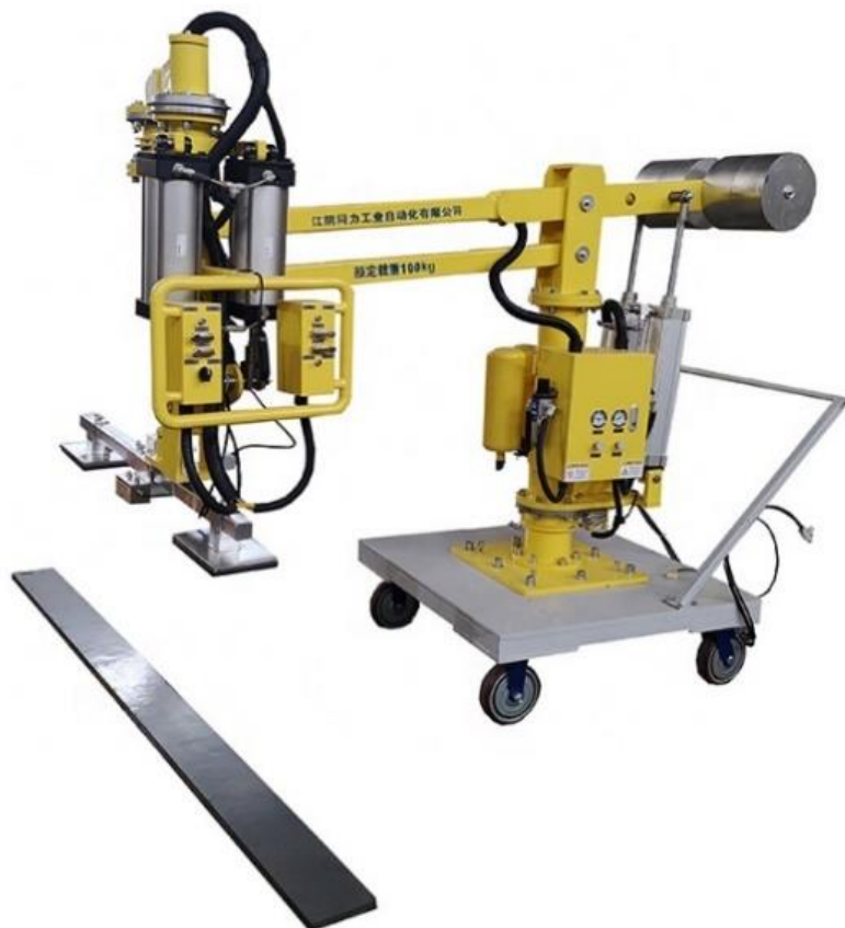
Slika 7. Ručni vakuumski manipulator za rukovanje trakama [6]
