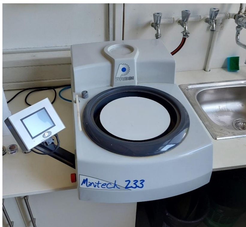
Slika 23. Uređaj za brušenje i poliranje Mecatech 250
