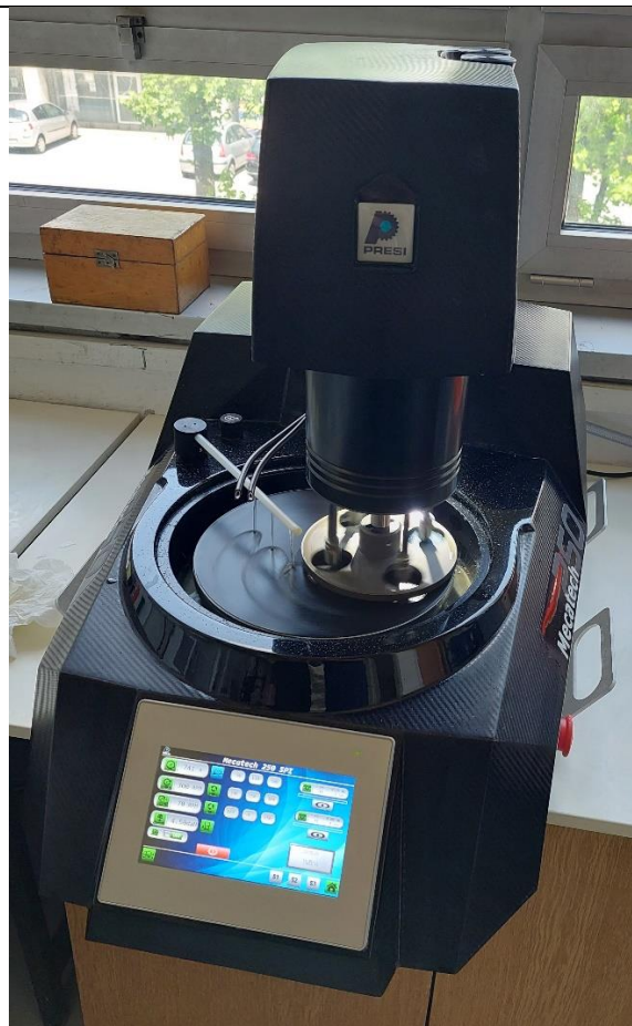
Slika 23. Uređaj za brušenje i poliranje Mecatech 250
