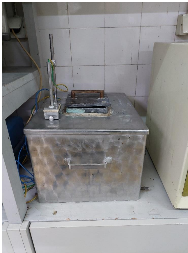
Slika 25. Stanica za elektrokemijsko nagrizanje
