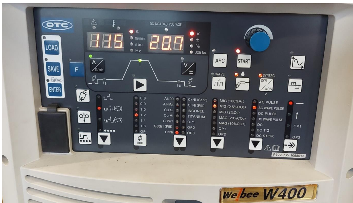
Slika 30. Prikaz sučelja izvora struje s odabranim postavkama
