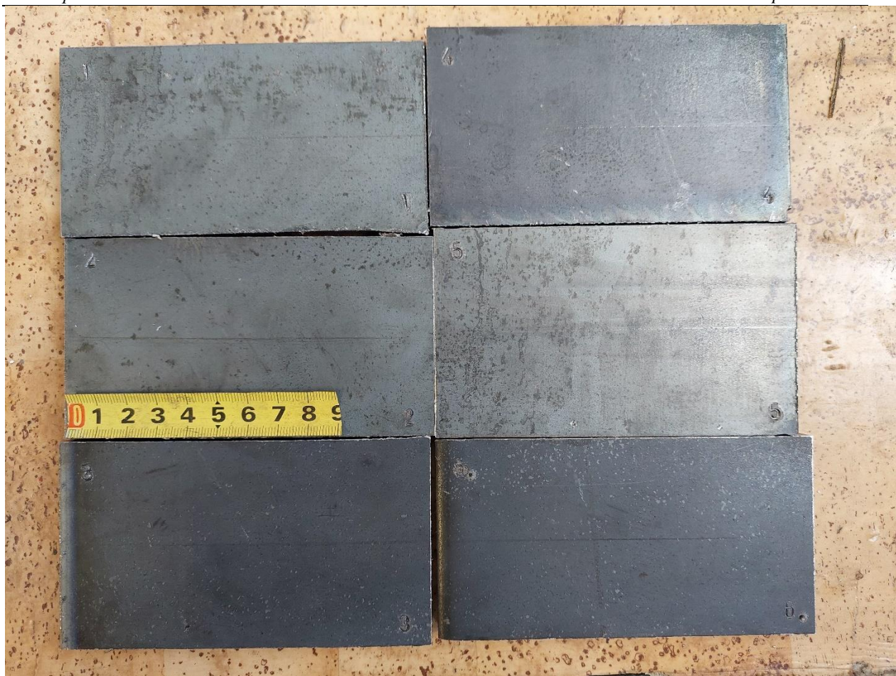
Slika 29. Pločice dimenzija 120x70mm nakon pripreme
