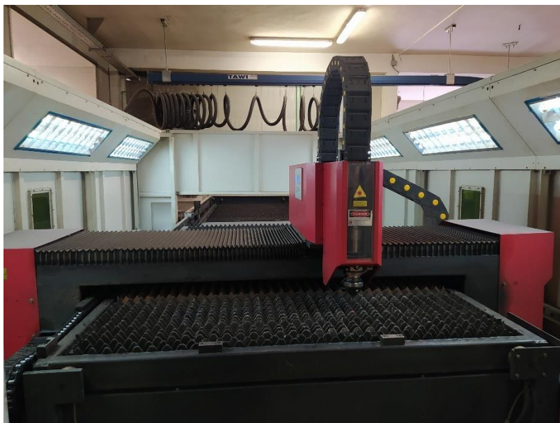
Slika 36. Laserski rezač korišten za izradu konstrukcije uređaja
