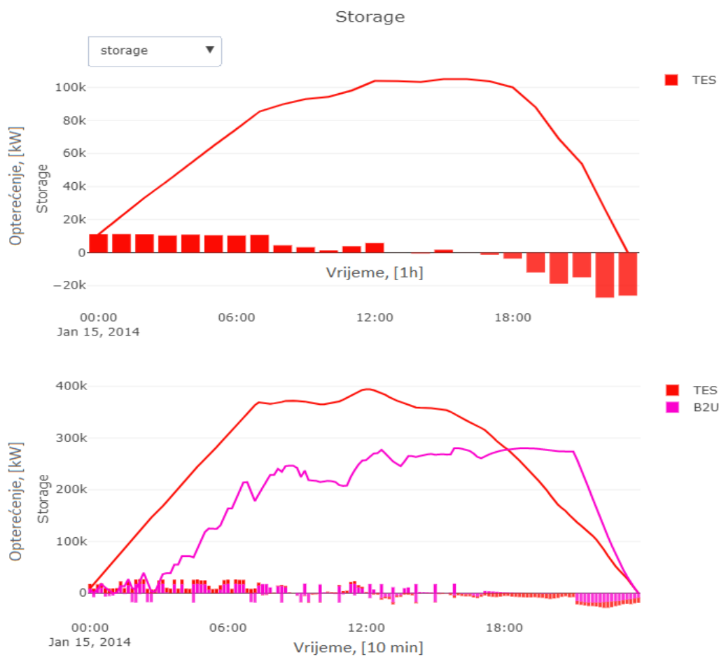
Slika 55. Energetski tokovi u i kapaciteti skladišta energije u satnom i 10-minutnom modelu dobiveni u programu Calliope
