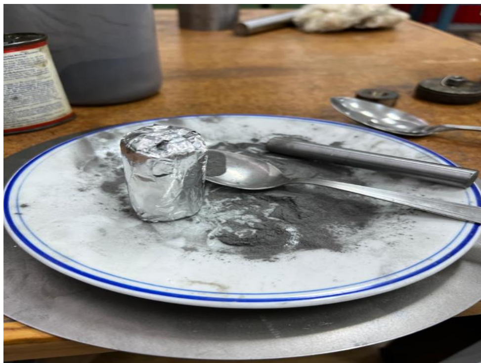
Slika 13. Prah u aluminijskoj košuljici
