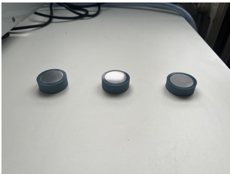
Slika 21. Uzorci nakon brušenja i poliranja
