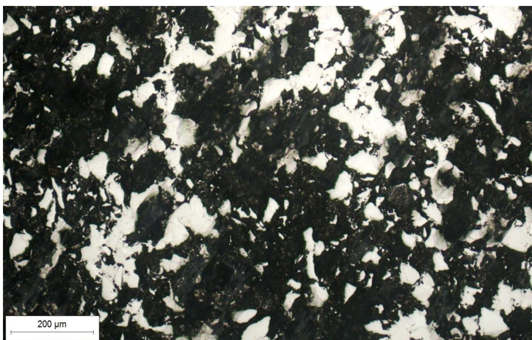
Slika 22. Mikrostruktura uzorka 1, 50x
