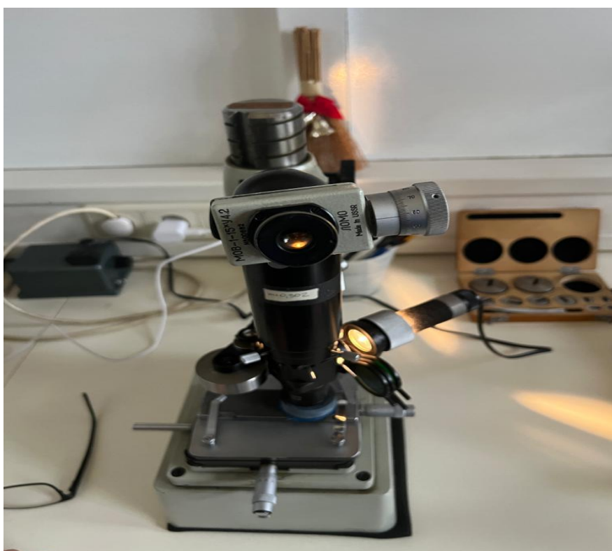
Slika 37. Uredaj za mjerenje tvrdoće
