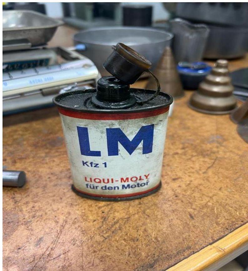
Slika 15. Ulje korišteno kao lubrikant kalupa
