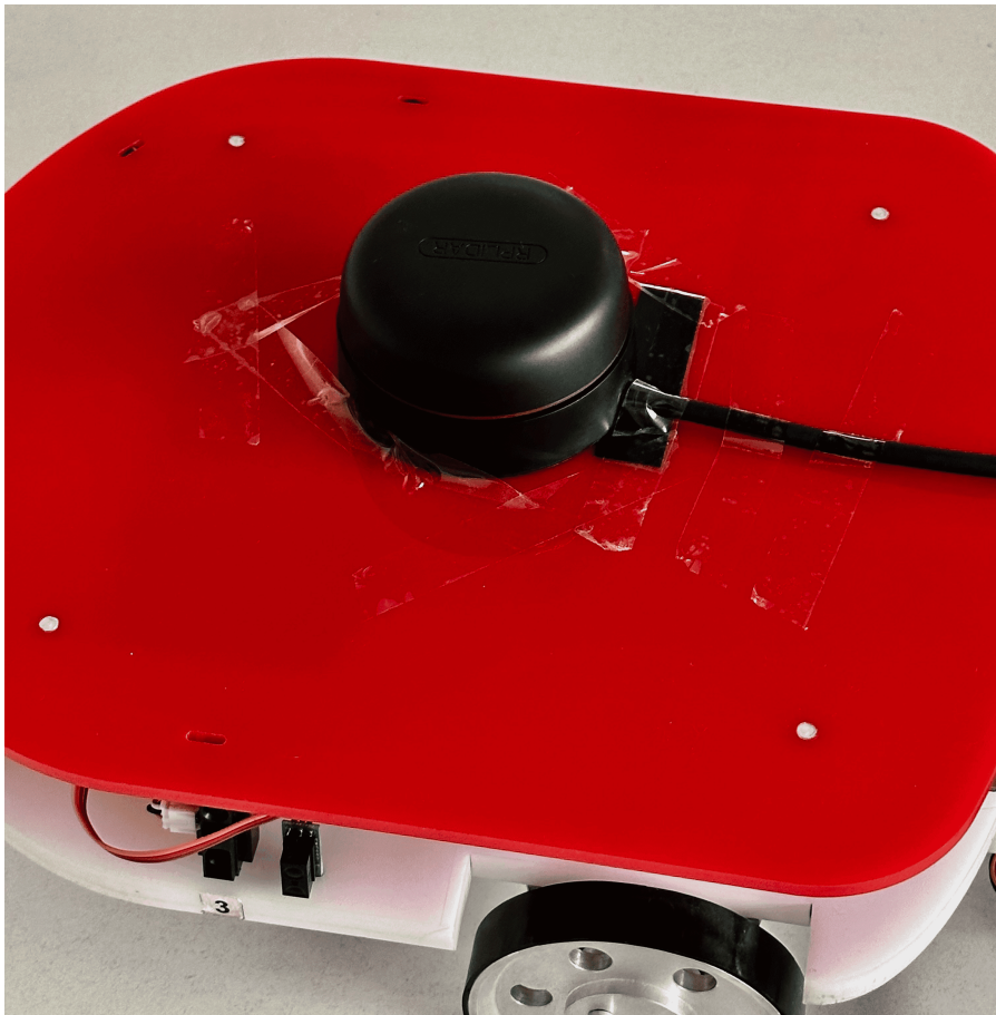
Slika 5.1: Lidar senzor RPLiDAR A2M8 postavljen na eMiR robota
