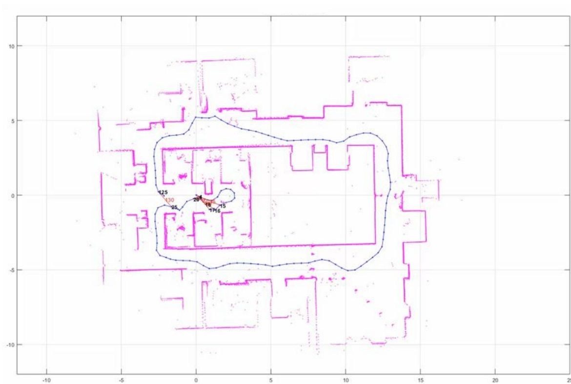
Slika 3.2: Ispravljena pogreška odometrije uz pomoć LIDAR podataka i odometrije [1]
